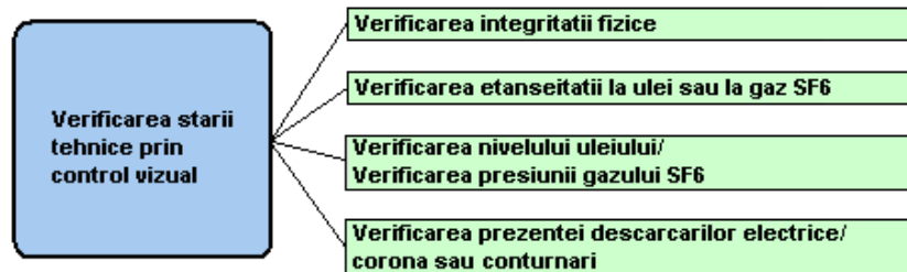
Fig. 3.14. Nomenclatorul de verificări la controlul vizual
