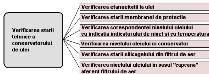
Fig. 3.9. Nomenclatorul de verificări la conservatorul de ulei
