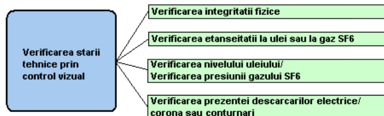
Fig. 3.18. Nomenclatorul de verificări la controlul vizual
