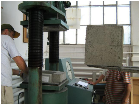
Fig. 6.17 Instalarea probelor pe standul de probă
