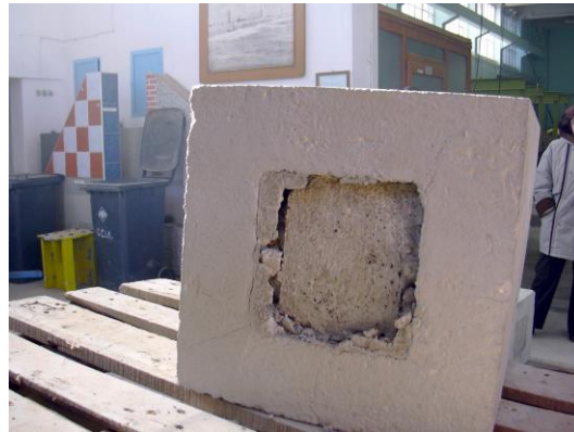
Fig. 6.35 Element încercat după testul de smulgere
