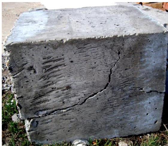
Fig. 6.37 Fisuri înclinate în urma testul de smulgere
