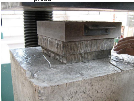
Fig. 6.18 Folosirea plăcuțelor de metal în partea de sus a probei
