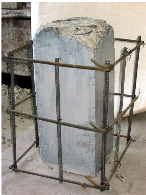
Fig. 6.13 . – Folosirea ca agent de legătură a rășinei epoxidice
