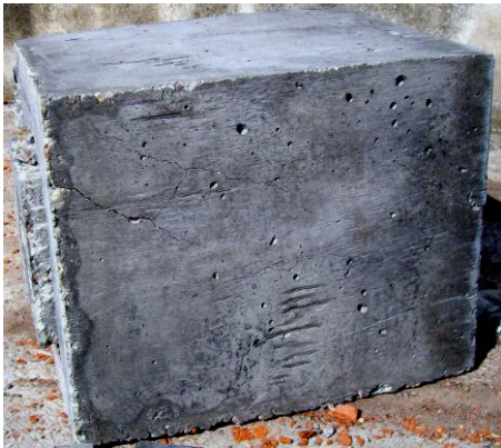
Fig. 6.34 Element încercat după testul de smulgere
