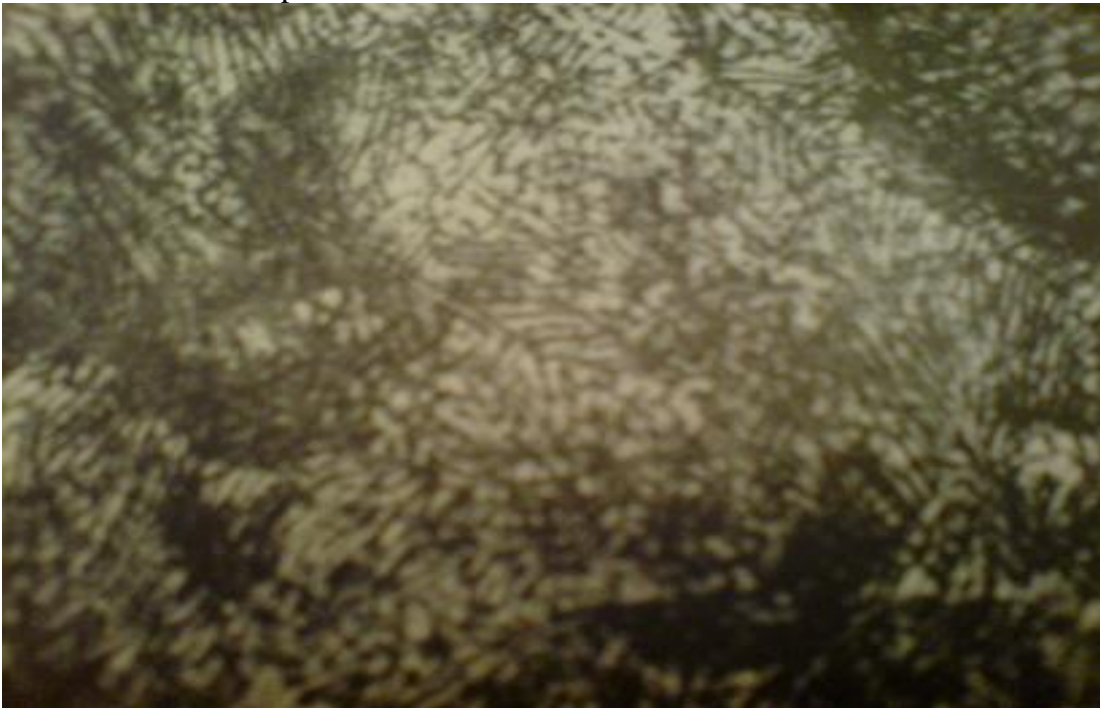
Fig.5.24 Microstructura reprezentand un oțel eutectoid (500:1, atac nital 2%)
