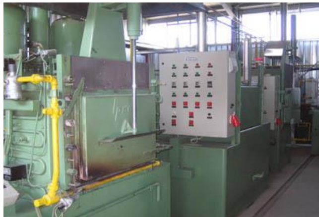
Fig. 5.22 Linie industrială pentru tratamente termice
