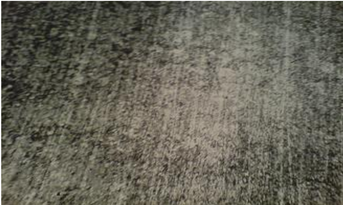
Fig.5.40 Microstructura otelului C45 supus calirii, la o temperatura de 875 grade Celsius si revenirii de 200 grade Celsius(100:1,atac nital 2%)
