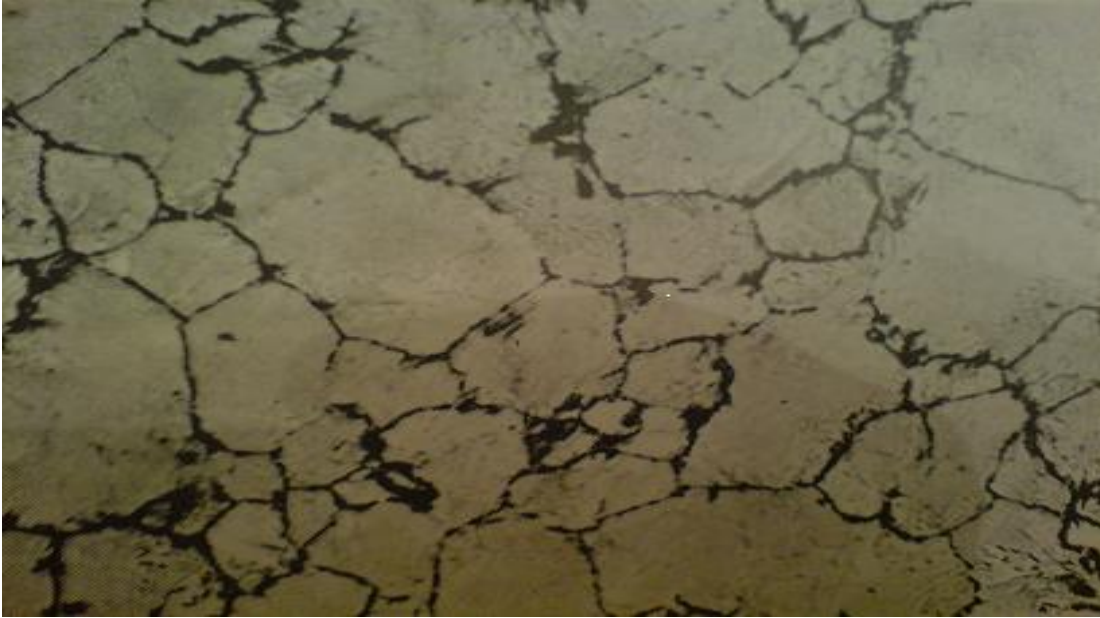
Fig.5.23 Microstructura reprezentand un oțel hipereutectoid (500:1, atac nital 2%)
