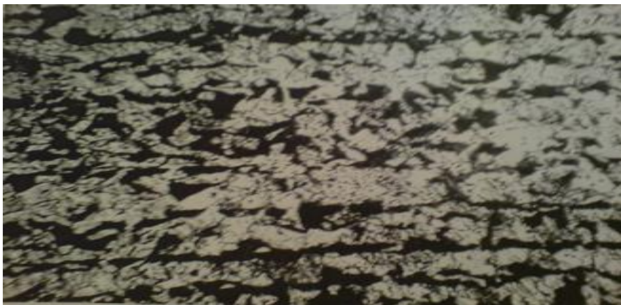
Fig.5.39 Microstructura reprezentând un C45 în stare netratată(500:1, atac nital 2%)
