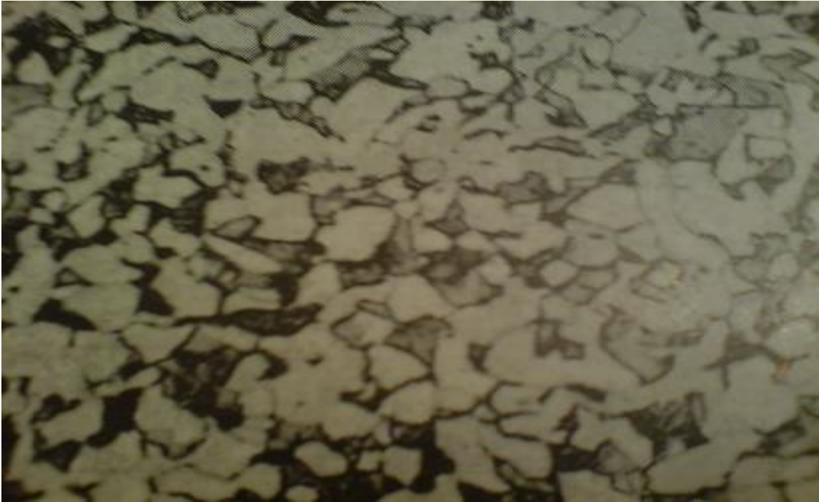
Fig. 5.25 Microstructura reprezentand un oțel hipoeutectoid (500:1, atac nital 2%)
