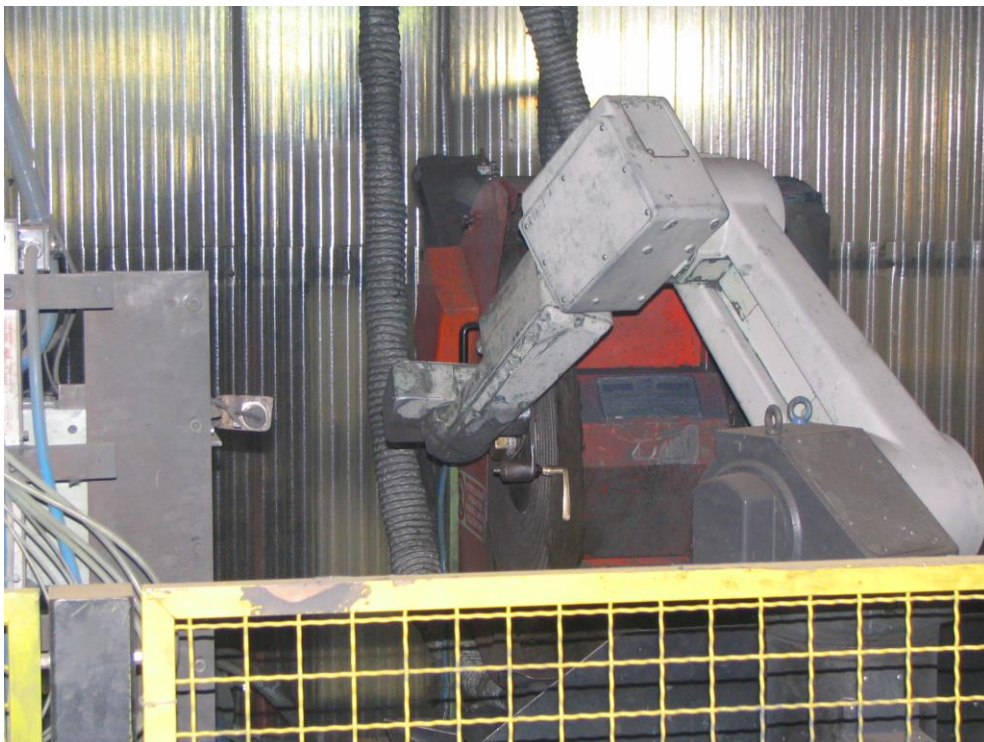
Fig. 7.9. Celula robotizată pentru operația de șlefuire
