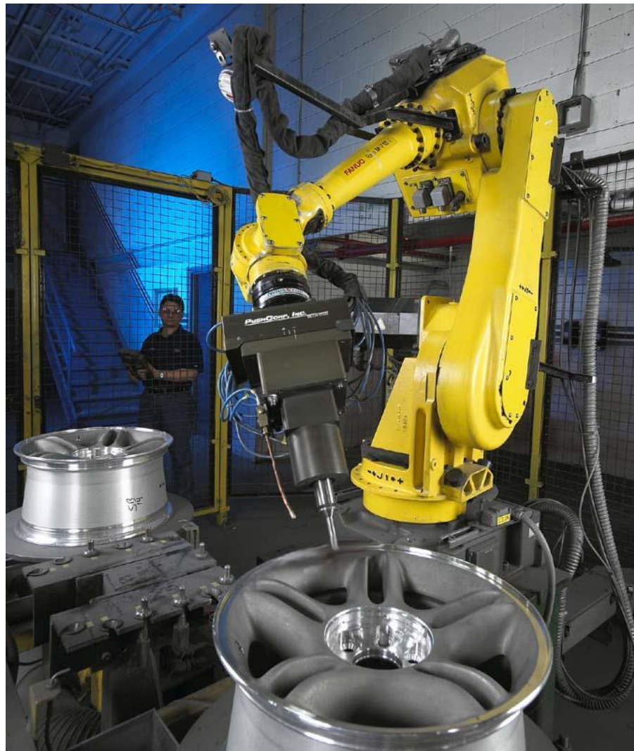
Fig. 2.1. SFF robotizat pentru șlefuirea jenților auto
