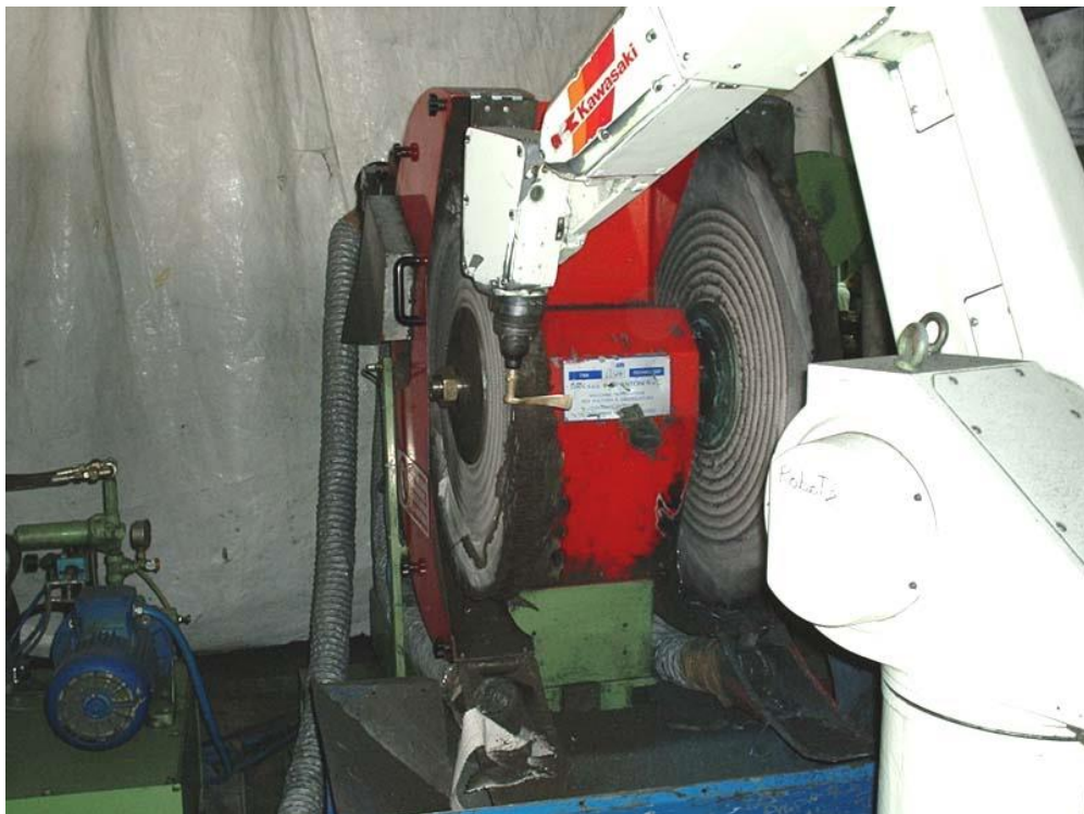
Fig. 2.7. Celulă pentru operație de șlefuire / lustruire a mânerelor de ușă
