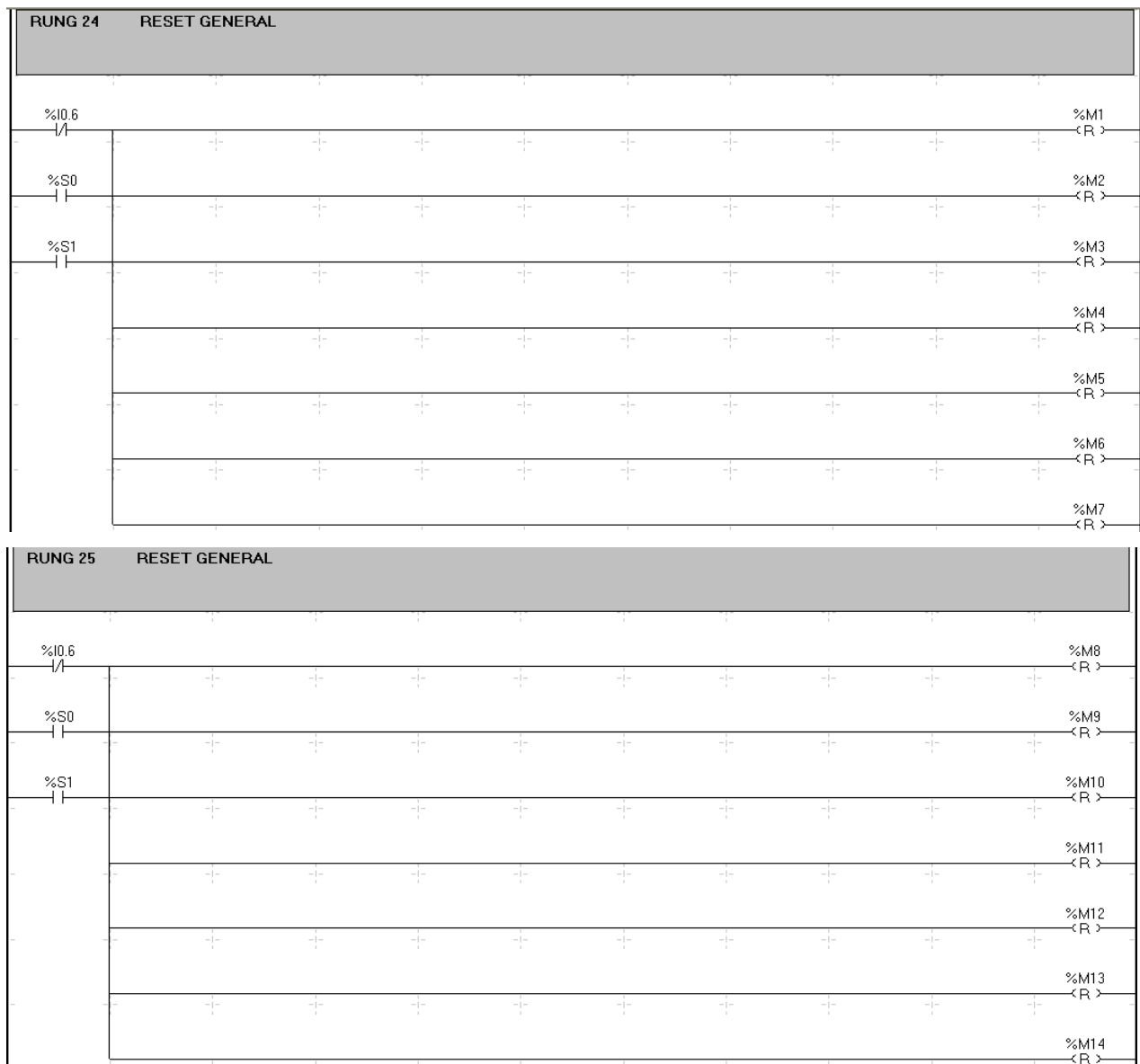
Fig. 8.13. Programul de comandă a PLC. - secțiunea 6
