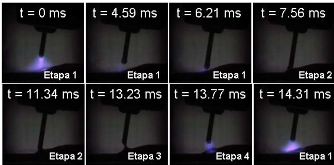
Fig. 3.12. Modul de transfer al picăturii în timp real
