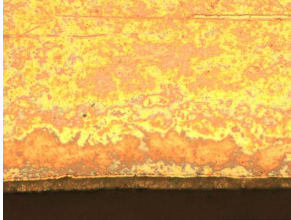
Fig 4.7 Evidențierea diferenței de grosime dintre stratul de Zn și oxid MO 500x
