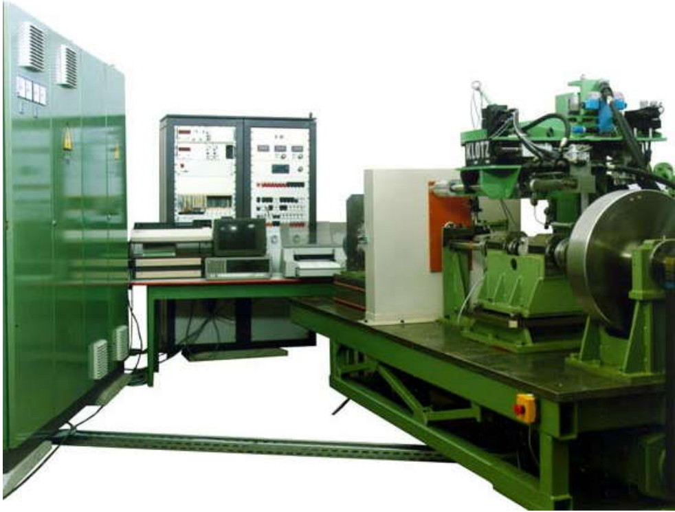
Fig. 2.7. Stand de testare cu flux energetic deschis produs de firma Klotz [W4]
