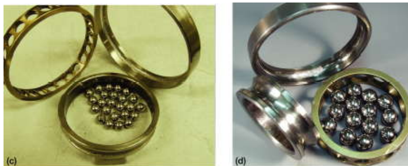
Fig. 2.31. Elementele uzate ale lagărelor de rostogolire duble (c), respectiv triple (d) [D2]
