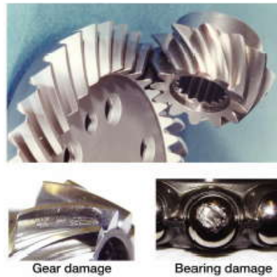
Fig. 2.36. Angrenajul conic înainte de testare și imagini ale flancului și rulmetului uzat, după efectuarea încercărilor [T2]
