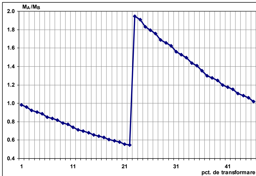
Fig. 4.10 Variația raportului momentelor normalizate aferente sensurilor A și B ale fluxurilor principale, funcție de poziția punctelor de transformare energo – cinematică (monobucă cu trei transmisii de testat)
