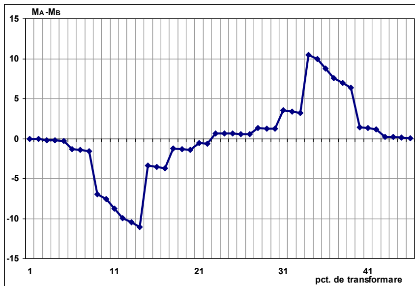
Fig. 4.9 Variația diferenței momentelor normalizate aferente sensurilor A și B ale fluxurilor principale, funcție de poziția punctelor de transformare energo – cinematică (monobucă cu trei transmisii de testat)
