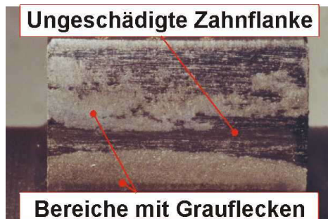
Fig. 2.20. Imagine a flancurilor uzate prin micropitting. Se pun în evidență zone neafectate ale flancului (Ungeschädigte Zahnflanke) și domenii extinse cu pete de uzare prin micropitting (Bereiche mit Grauflecken) [W20]
