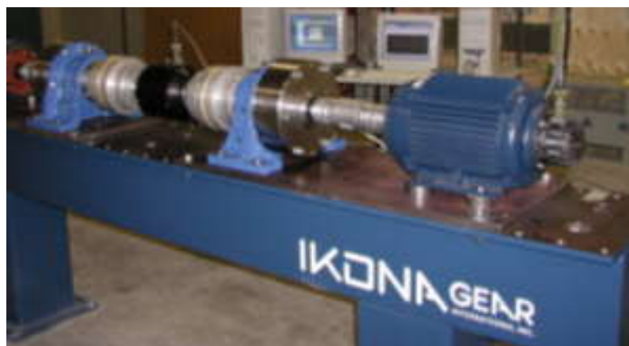
Fig.2.8. Stand de testare cu flux energetic deschis produs de Ikona Gear [W7]
