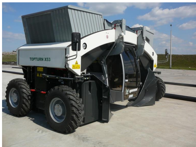
Figura nr. 3.4.8.-1. Mașină de mașină de învârtire a prisme de compost
