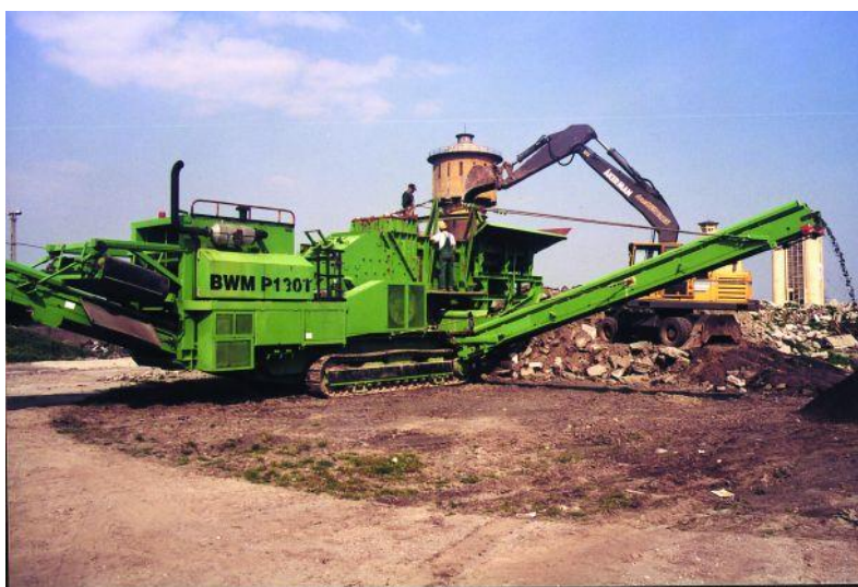
Figura nr. 3.4.10.-1. Concasor betoane
