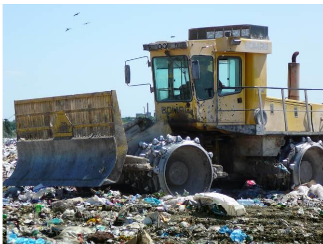
Figura nr. 5.6.2.-2.Compactor picior de oaie tip BOMAG 33 tone
