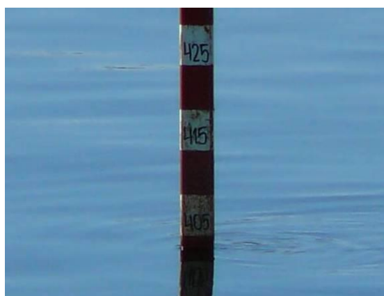
Figura nr.5.7.6.-4. Mira din bazinul de colectare levigat
