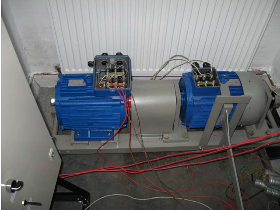
Fig. 4.18. Stand experimental cu mașina de inducție de construcție specială cu înfășurări de excitație și sarcină separate.
