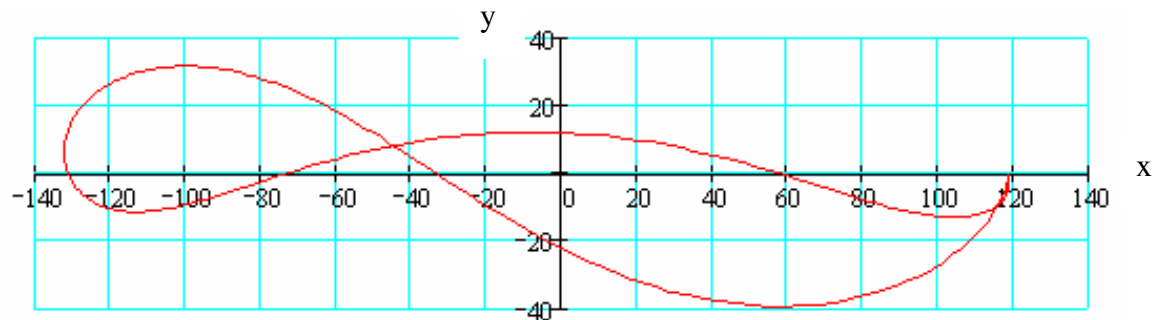
Fig.1.45 Profilul rezultat cu parametrii k=3 ; \beta_0=0,17 ; R=50 ; \xi_c=-10 ; \eta_c=5
