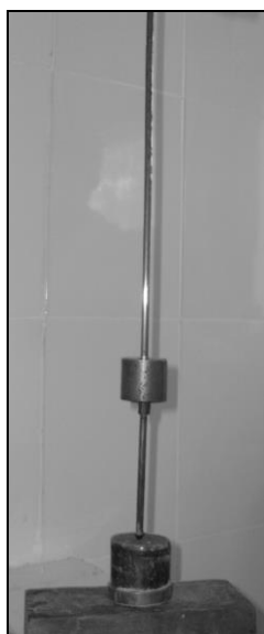
Figura 4.26. Penetrometru de laborator pentru determinarea rezistenței la penetrare
