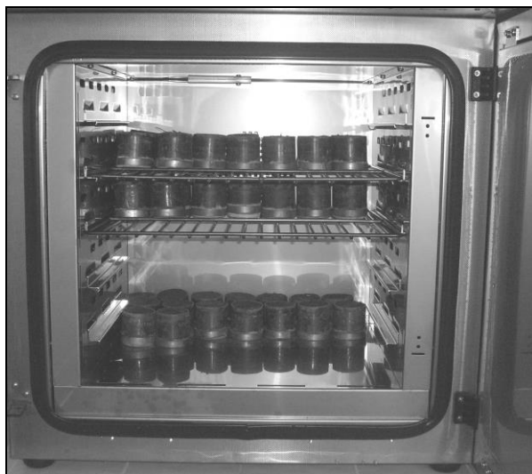
Figura 4.25. Cilindri pentru determinarea densității aparente la uscare, în etuvă
