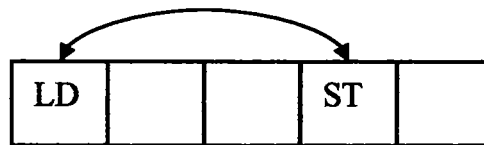
Figura 6.4. Coadă de instrucțiuni de accesare a memoriei. Exemplu de predicție store set .
