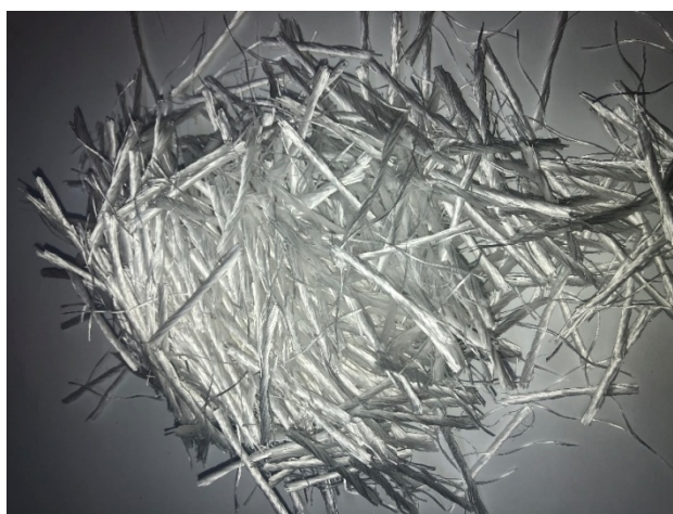
Figura 37. Macrofibre din polipropilenă, Readymesh PF 540
