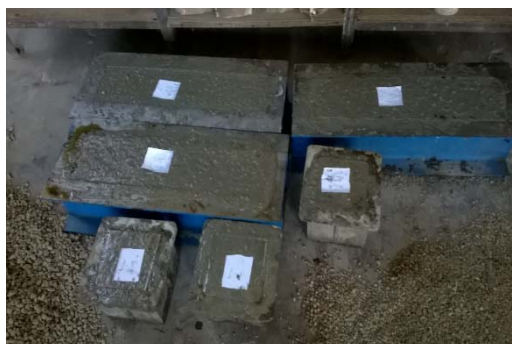
Figura 24. Probe de beton armat cu strat de 5 cm cu fibre de oțel
