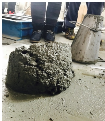
Figura 23. Tasarea betonului proaspăt armat dispers cu fibre metalice
