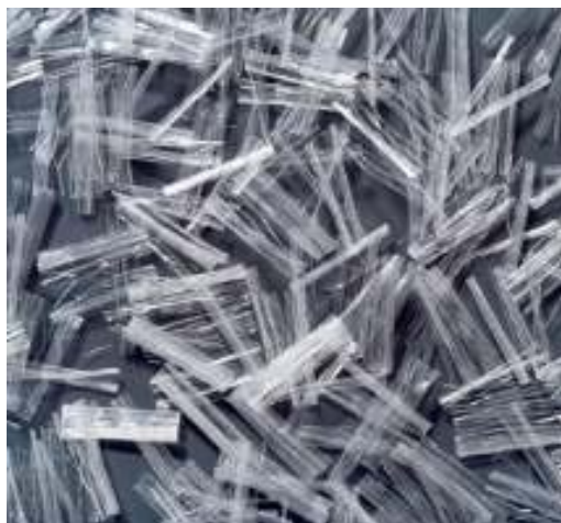
Fig. 13. Fibre fibrilate de polipropilenă
