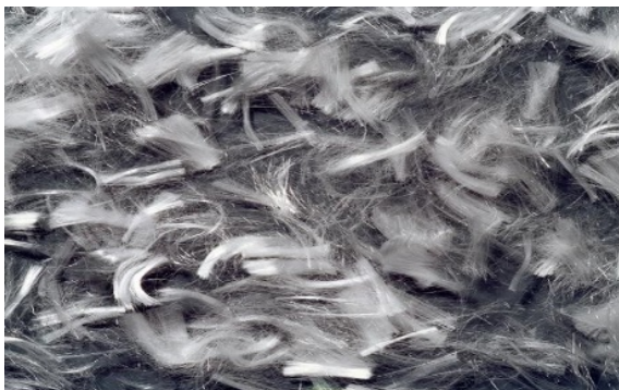
Fig. 12. Fibre de polipropilenă monofilament
