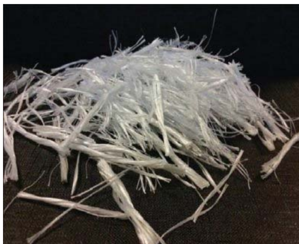
Fig. 11. Fibre de polipropilenă
