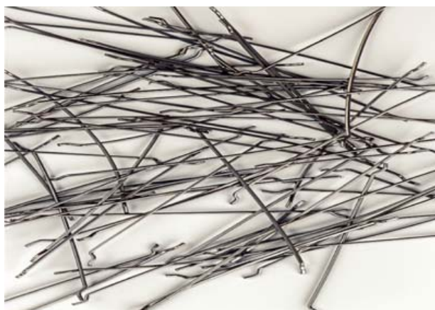
Fig. 3. Fibre metalice cu ciocuri – RFC
