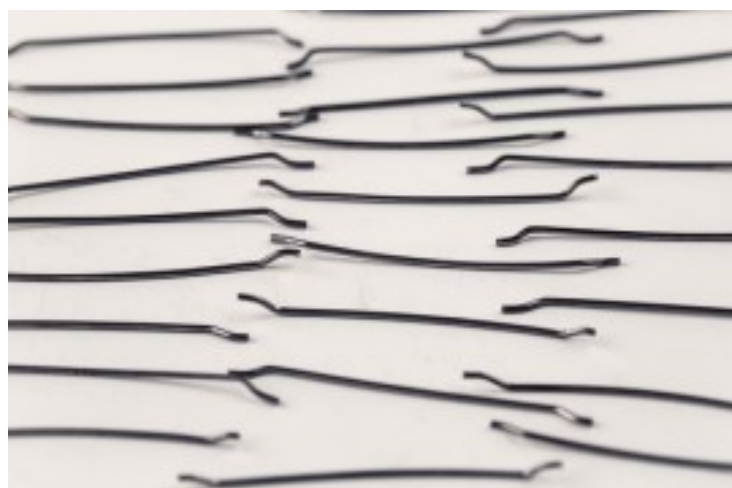
Figura 20. Fibre metalice cu ciocuri
