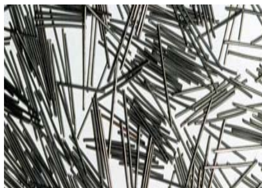
Fig. 6. Fibre metalice circulare
