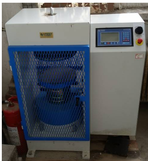
Figura 50. Presa hidraulică automată
