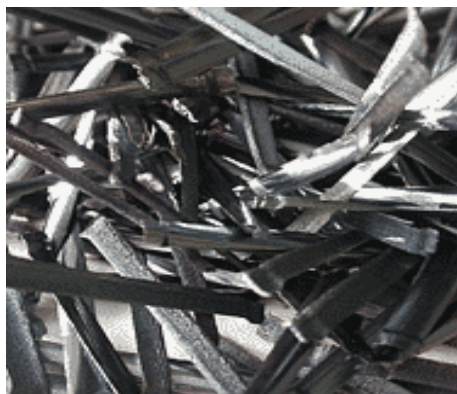
Fig. 7. Fibre frezate cu secțiune triunghiulară
