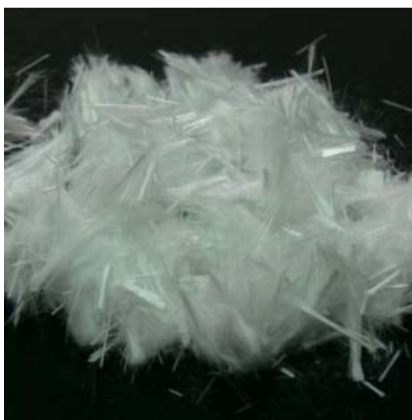
Fig. 9. Fibre de sticlă boro-silicatică, denumită sticla E
