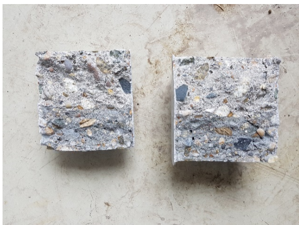
Figura 52. Testarea carotelor la despicare
