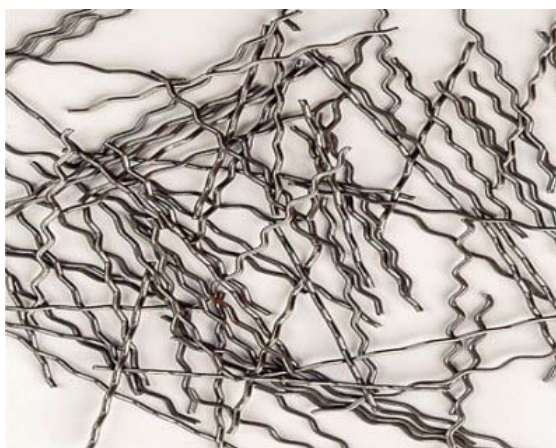
Fig. 4. Fibre metalice ondulate – RFO
