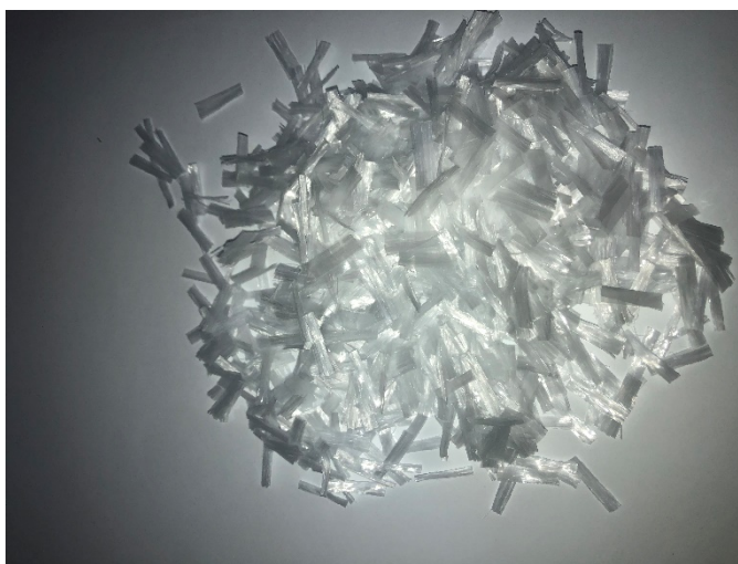
Figura 33. Fibre fibrilate din polipropilenă, RoNet 19 mm [28]
