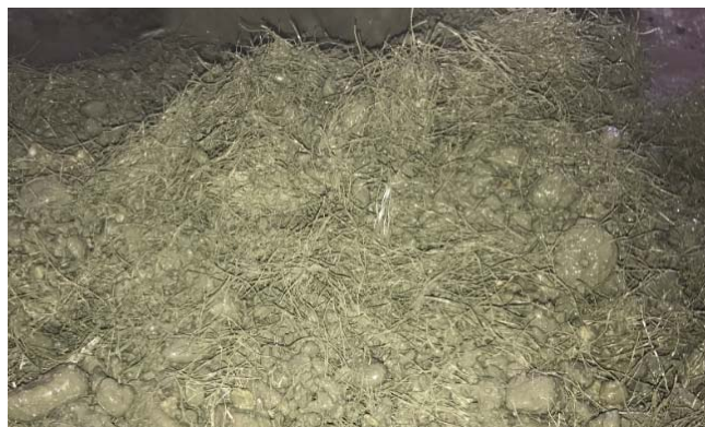
Figura 38. Distribuția macrofibrelor Readymesh PF 540 după amestecare
