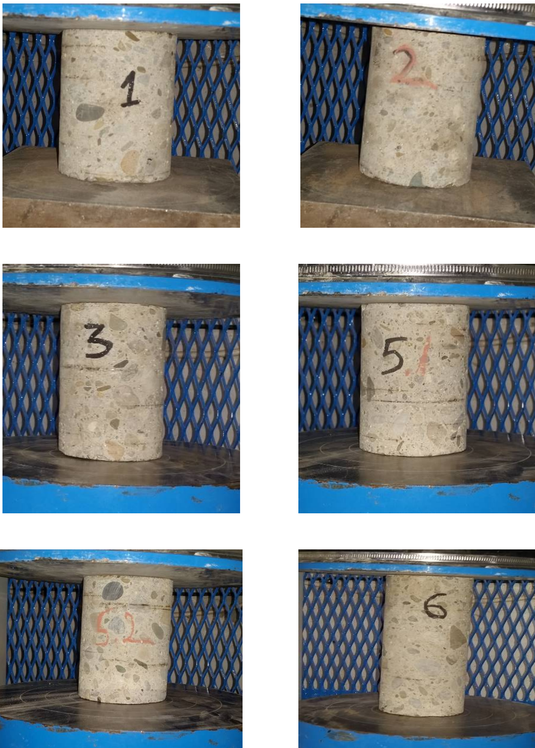
Figura 51. Testarea carotelor la compresiune
