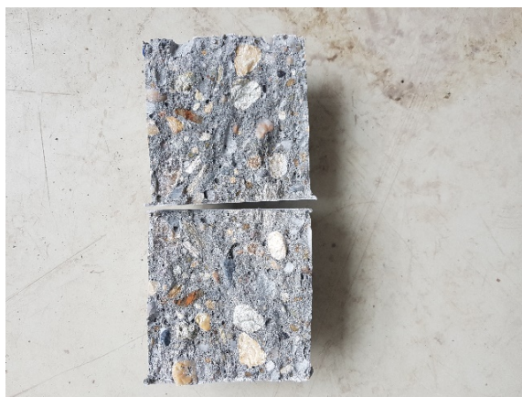
Figura 52. Testarea carotelor la despicare
