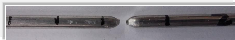
Figura 5.28. Aspectul sârmei de Al rupte prin tracțiune
