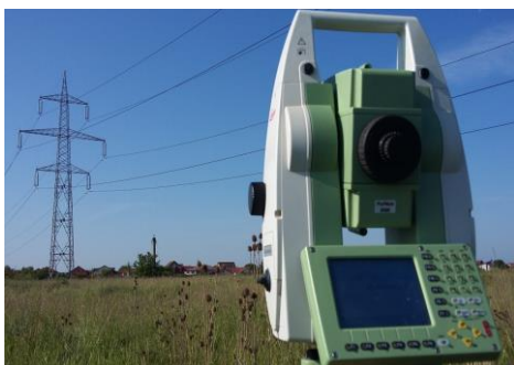
Figura 3.30. Tahimetru electronic Leica 1103+
