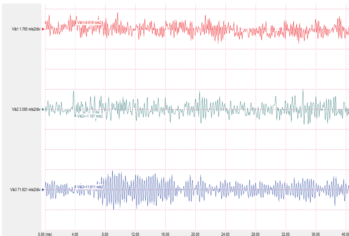
Fig. 6.4 – Forma de undă a vibrațiilor în regim de mers în gol neexcitat.
