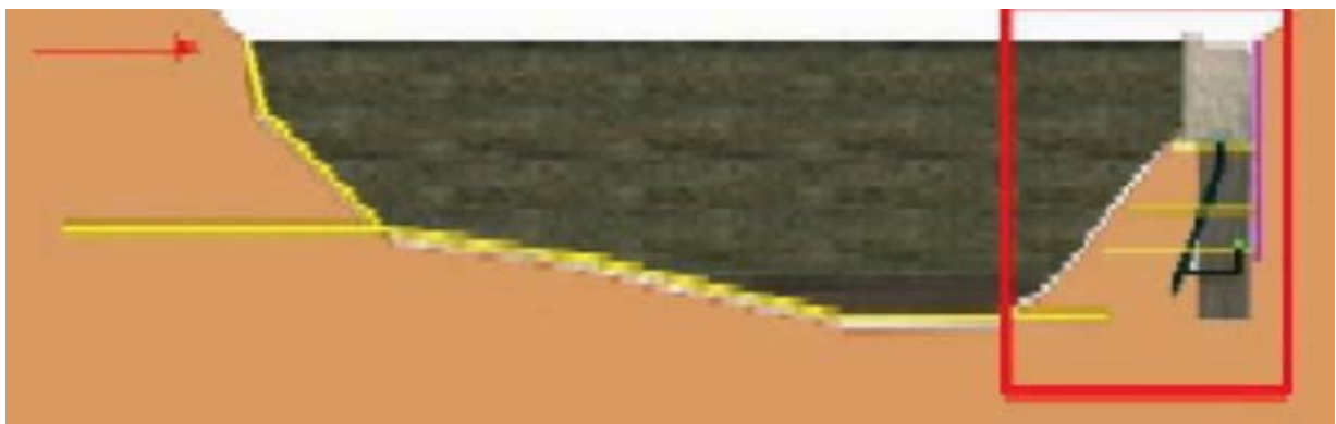
Fig. 2.4- Galeria de injecție
