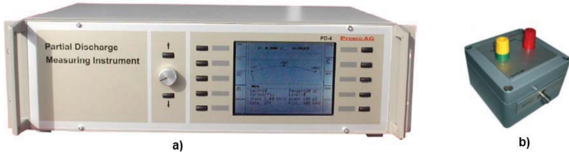
Fig. 6.33 – Sistem de măsurare a descărcărilor parțiale
