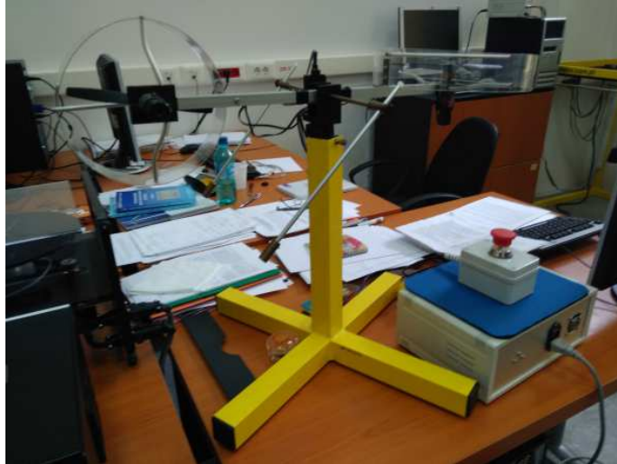
Fig.1.3.2. Sistemul aerodinamic cu două rotoare din laboratorul B029 al Departamentului de Automatică și Informatică din cadrul Universității Politehnica Timișoara.
