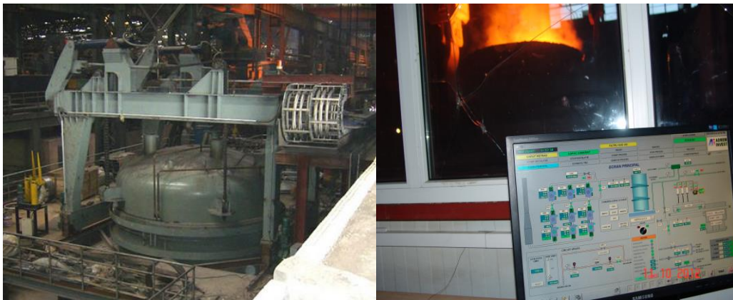
Fig. 2.6. Instalație VD vedere generală și conducere automată [26].
