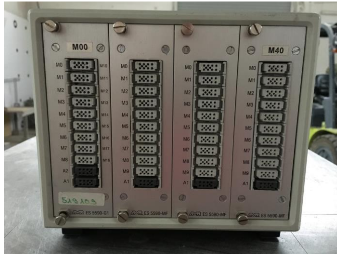
Fig. 4.28. Sistem achiziții date Almemo 5990-0-Ahlborn [96]
