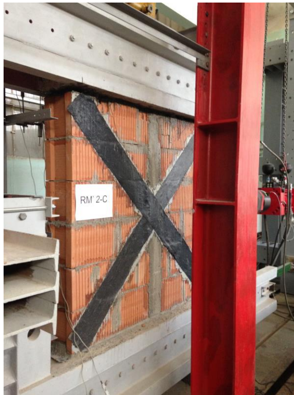
Fig. 4.24. Elemente zidărie consolidate cu țesătură din fibră de carbon – montate în standul experimental
