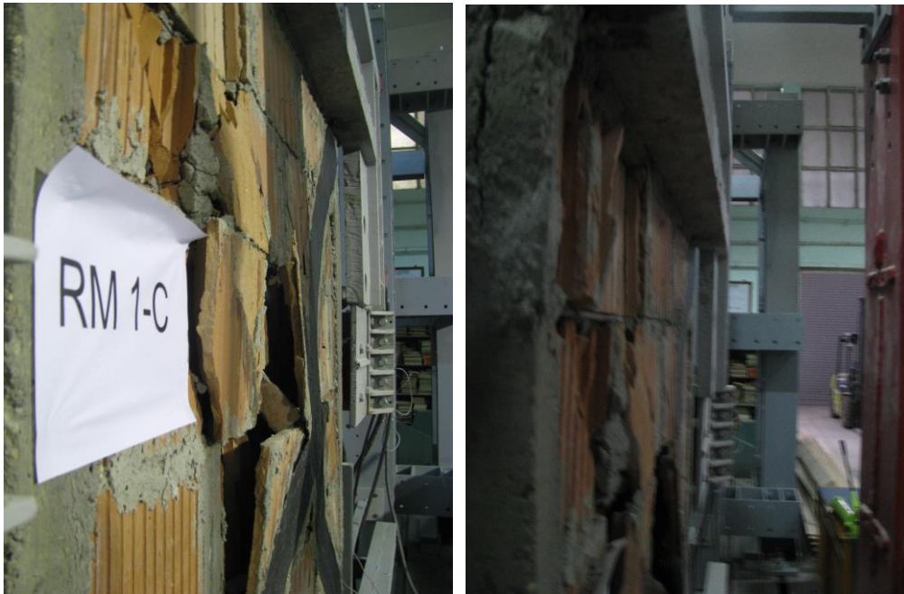
Fig. 5.39. Avarii ale elementului RM1-C – zidărie confinată cu stâlpișori laterali consolidată
