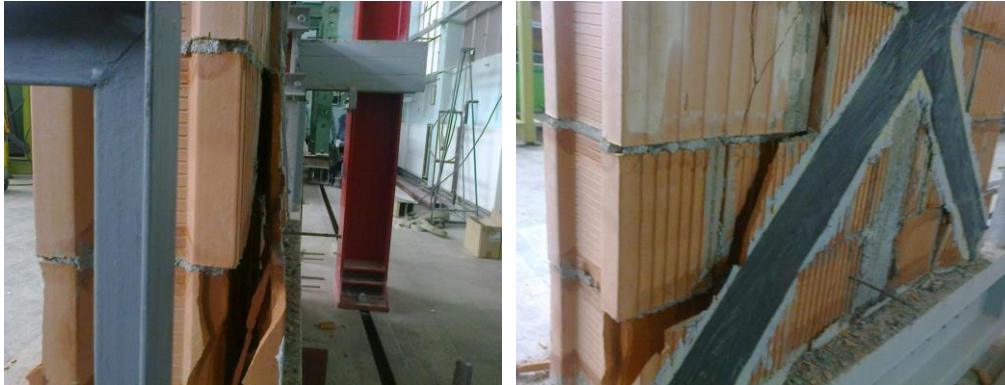
Fig. 5.48. Avarii ale elementului RM2-C – zidărie confinată cu stâlpișor central consolidată
