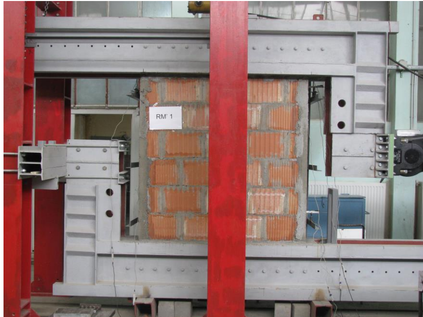
Fig. 4.12. Specimene pereți zidărie montați în standul experimental
