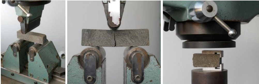
Fig. 4.16. Încercare probe mortar la încovoiere și compresiune
