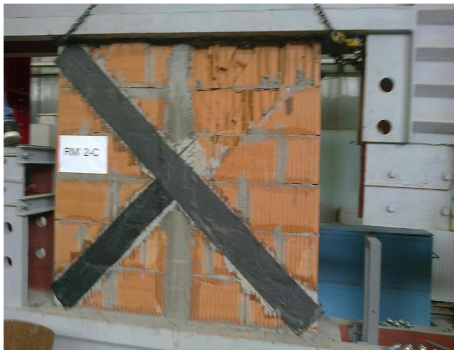
Fig. 5.48. Avarii ale elementului RM2-C – zidărie confinată cu stâlpișor central consolidată
