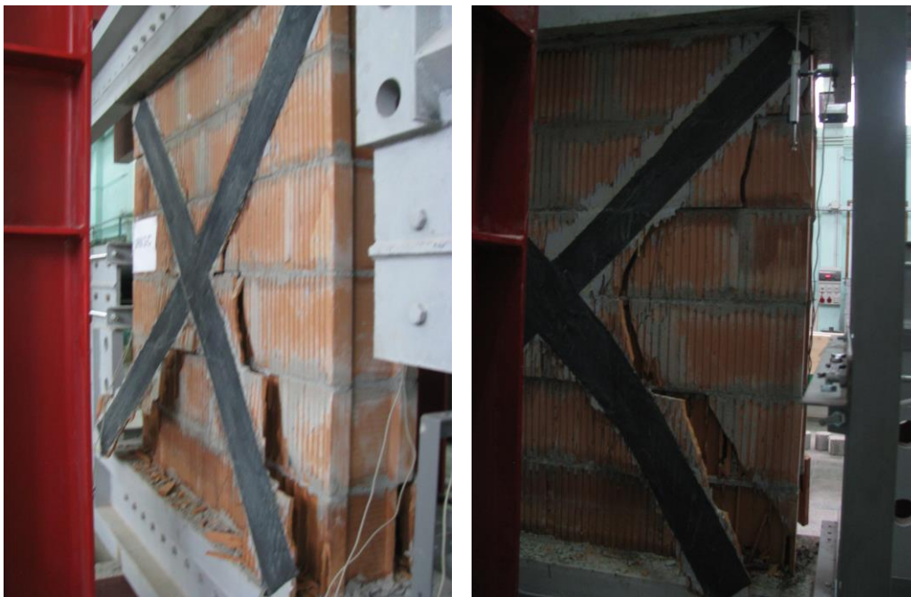
Fig. 5.31. Avarii ale elementului URM2-C – zidărie nearmată consolidată
