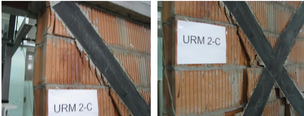
Fig. 5.31. Avarii ale elementului URM2-C – zidărie nearmată consolidată
