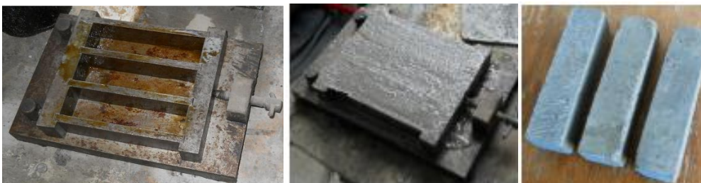
Fig. 4.15. Prelevare epruvete prismatice mortar
