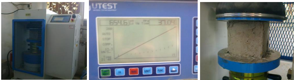
Fig. 4.17. Încercare cuburi beton – aparat și rezultate
