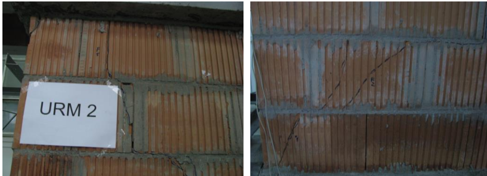
Fig. 5.4. Avarii ale elementului URM2 – zidărie nearmată
