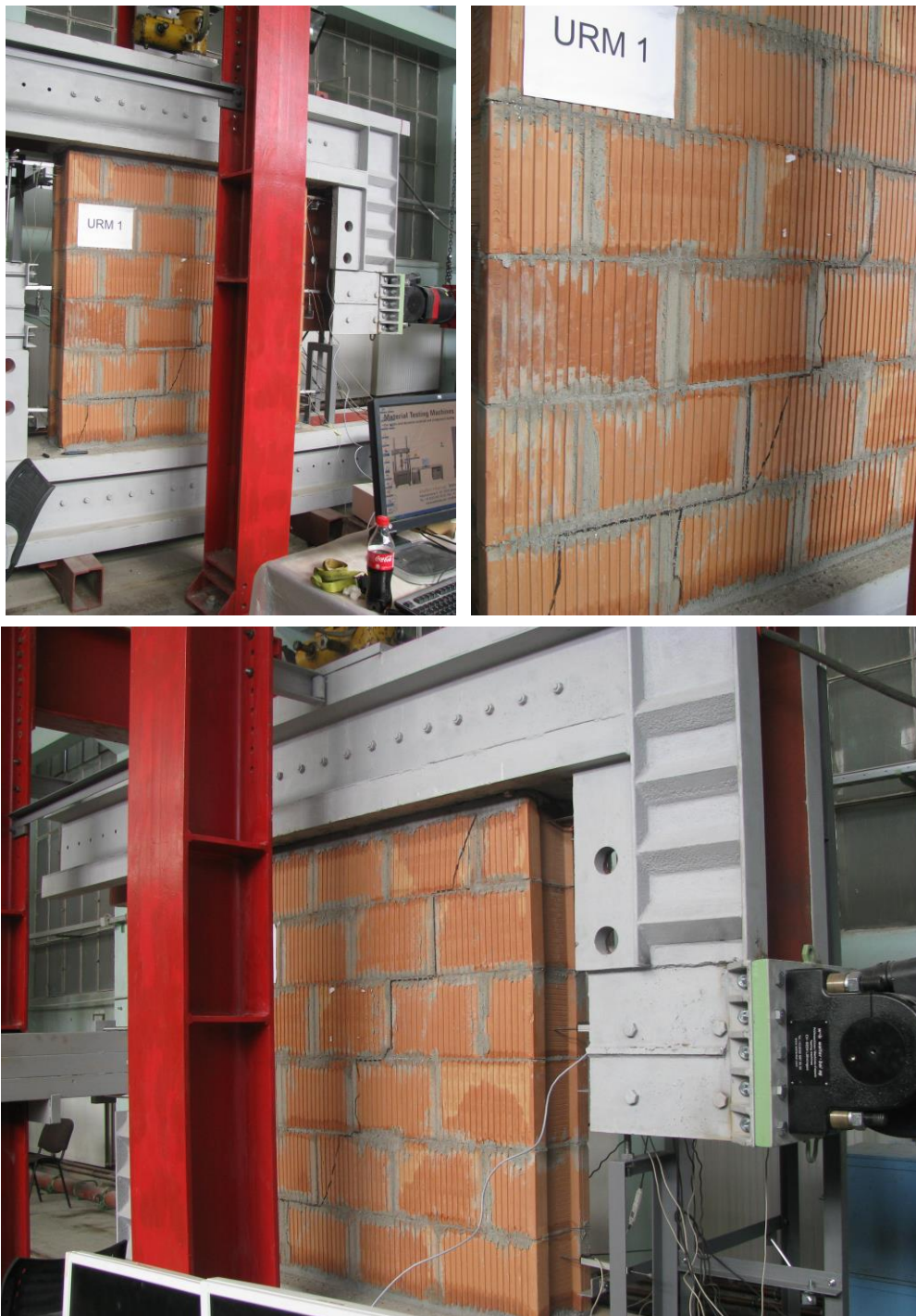
Fig. 5.3. Avarii ale elementului URM1 – zidărie nearmată
