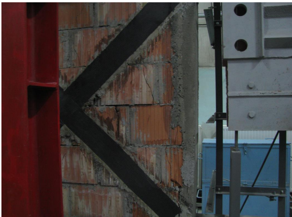
Fig. 5.39. Avarii ale elementului RM1-C – zidărie confinată cu stâlpișori laterali consolidată
