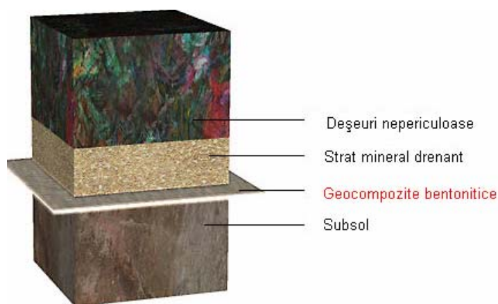
Fig.7.2. Etanșarea deponeurilor și exploatărilor miniere (etanșare simplă)
