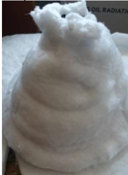
Figura 3.22 Pâlnie izolată fibră ceramică
