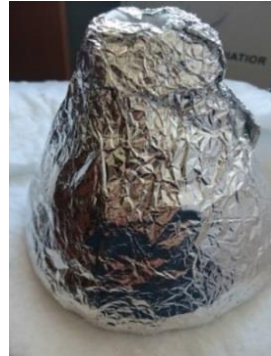
Figura 3.23 Pâlnie izolată fibră ceramică și folie aluminiu
