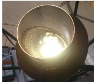
Figura 3.20. Instalație experimentală vas cu apă pentru determinare randament lentilă Fresnel
