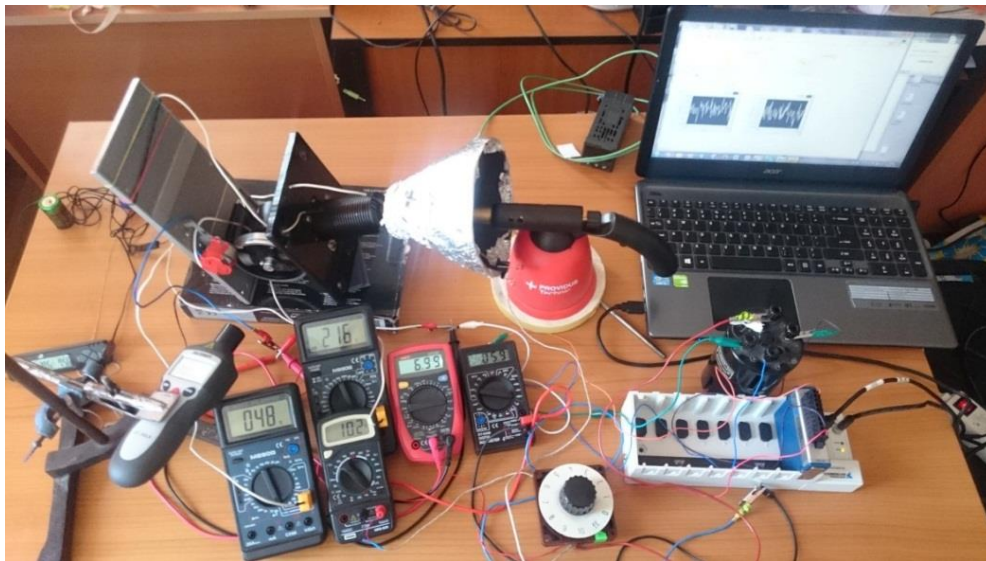
Figura 3.1. Imagine de ansamblu a instalației experimentale de laborator cu motor Stirling tip beta
