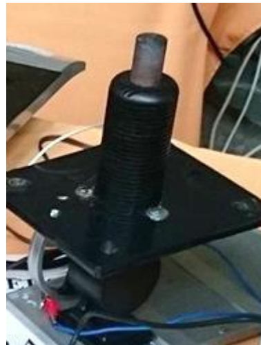
Figura 3.13 Motorul Stirling tip beta utilizat
