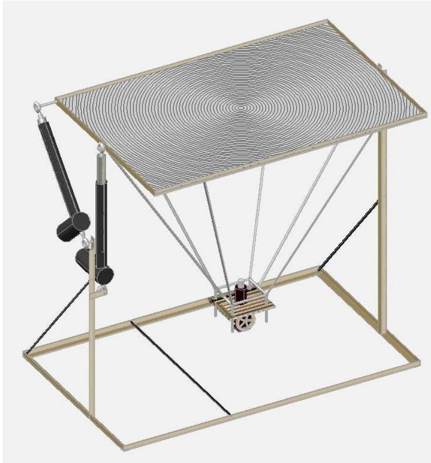
Figura 3.6 Schema de principiu a instalației pilot - cadru suport vedere izometrică – prototip 3
