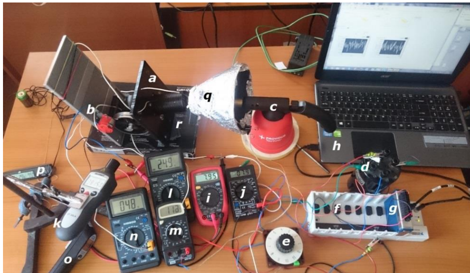
Figura 6.4. Imagine de ansamblu a instalației experimentale de laborator cu motor Stirling tip beta
