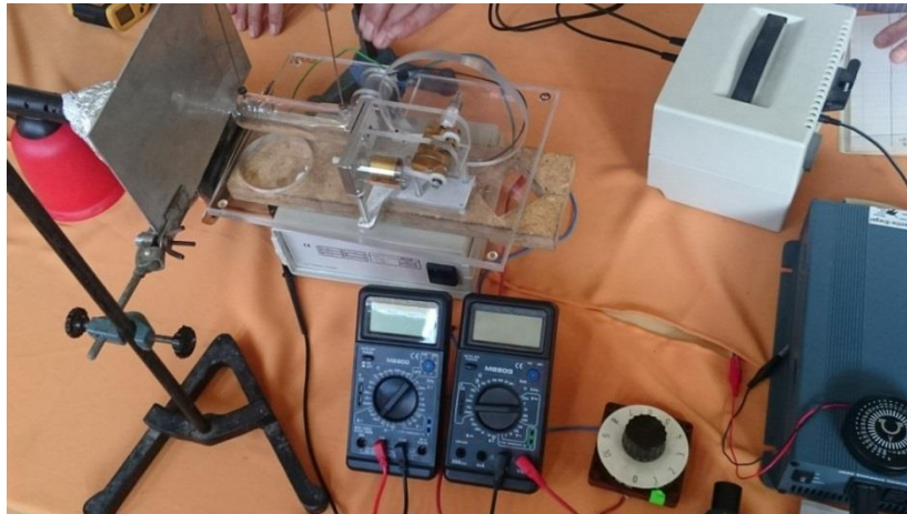
Figura 3.2 Imagine de ansamblu a instalației experimentale de laborator cu motor Stirling tip gamma
