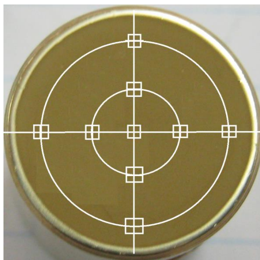
Fig.7.1. Schema celor 18 zone de măsurare a parametrilor rugozității Ra, Rz și Rt
