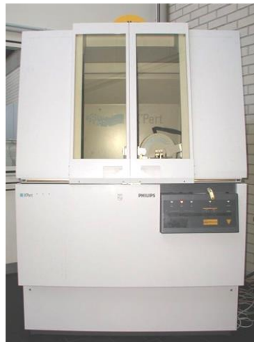
Fig.2.11. Difractometrul de raze X (X'Pert de la firma Philips)
