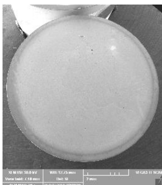
Fig.5.22. Macrografia suprafeței probelor nitrurate: x 20
