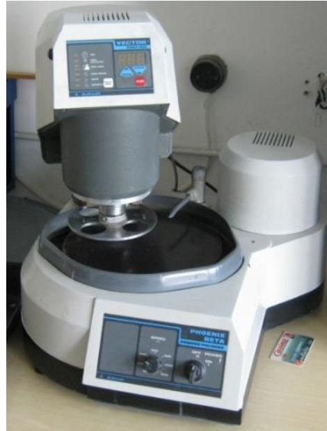
Fig.2.7. Aparatul de șlefuit și lustruit Buehler Phoenix Beta
