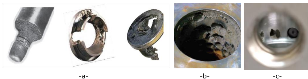
Fig.1.7. Elemente de aparatura hidraulică, deteriorate prin cavitație: a-eroziune sertar și scaune de așezare, b,c-eroziune pe corpul aparatelor [131, 133]
