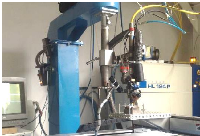
Fig.4.2. Microunitate laser, marca Trumpf HL 124 P
