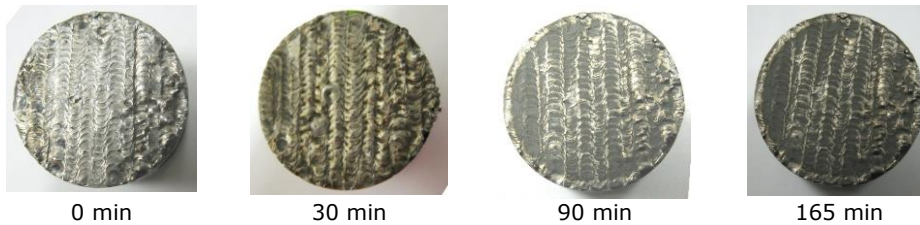
Fig.4.3. Degradarea suprafeței de atac la diferite intervale de timp
