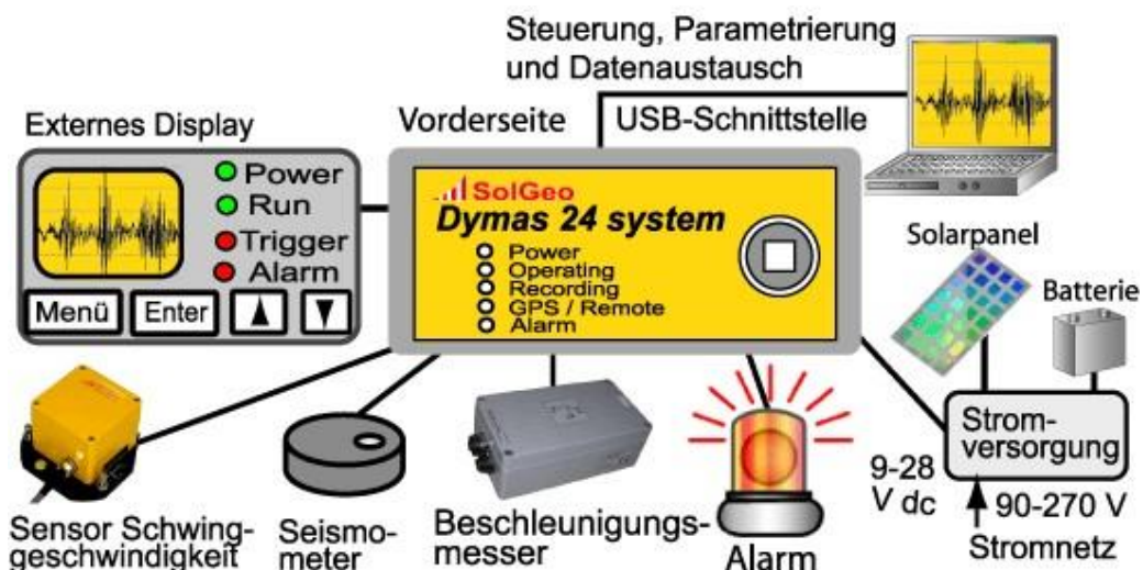
Fig. 6.10. Sistem de măsurare a vibrațiilor conform DIN 4150 Partea 2 și 3
