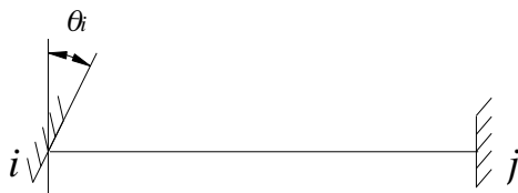
Fig. 4.17. Bară dublu încastrată cu rotire de reazem
