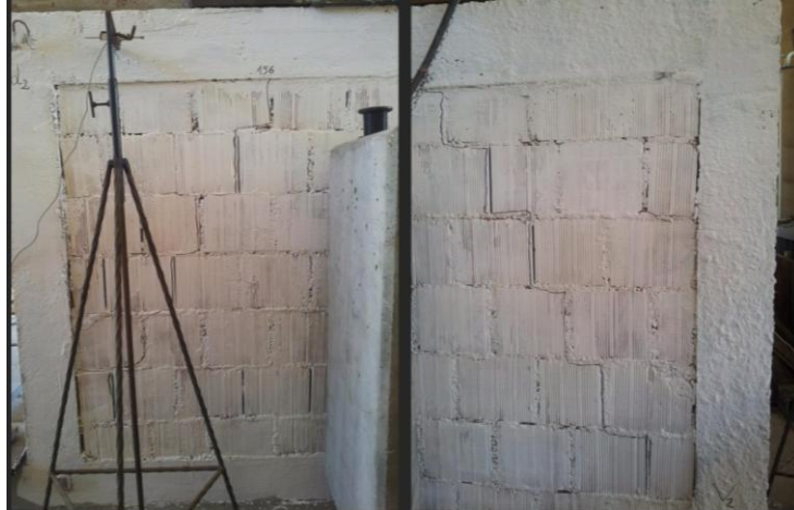
Fig. 4.36. Prezentarea cadrului cu mustăți de ancorare umplut cu zidărie marca Europoron după apariția fisurilor
