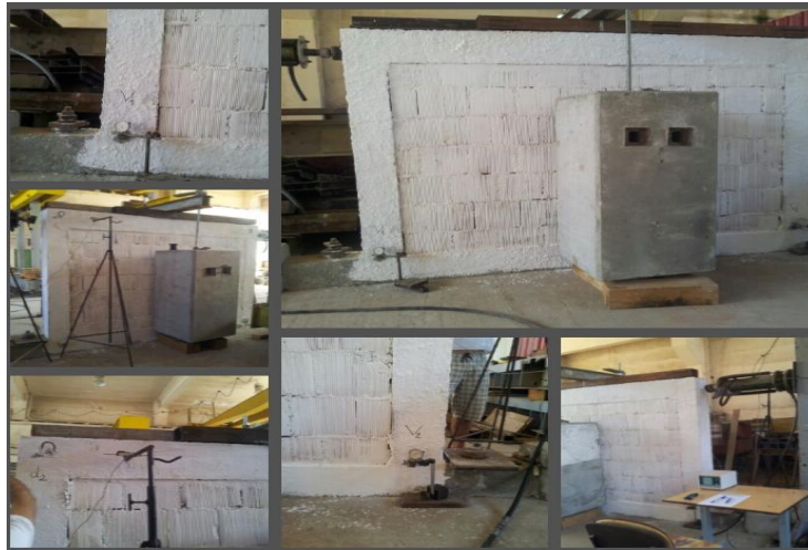
Fig. 4.34. Presentarea cadrului cu mustăți de ancorare umplut cu zidărie marca Europoroton
