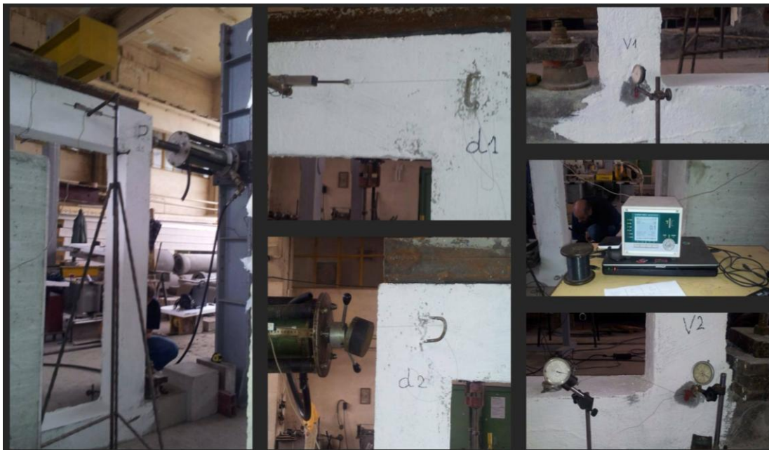
Fig. 4.24. Modul de dispunere a deflectometrelor
