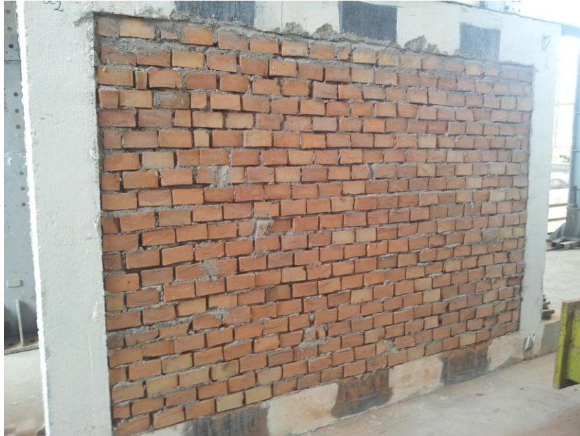
Fig. 4.42. Prezentarea cadrului cu mustăți de ancorare umplut cu cărămidă plină
