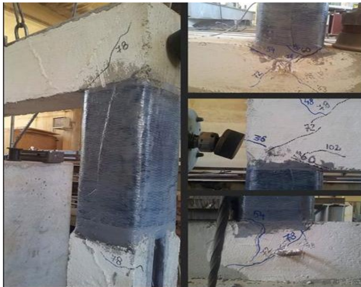
Fig. 4.33. Cadrul martor consolidat fisurat
