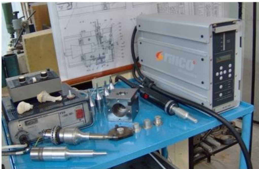
Fig.4.15. Echipamentul ultrasonic-generatoare și convertoare (transductor+concentrator) [construcție UPT]
