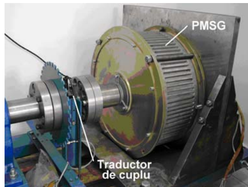
(h) Generatorul PMSG și traductorul de cuplu mecanic.
