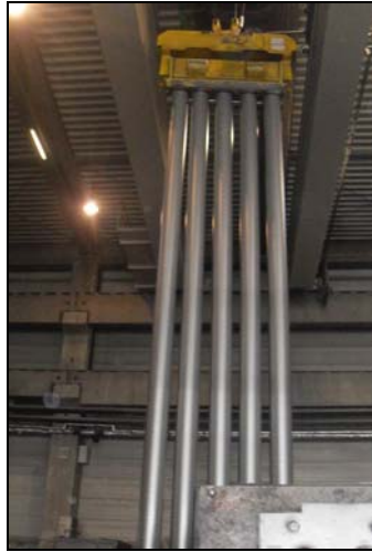
Fig.5.30. Extragere bare de aluminiu și pregătire pentru tratament termic
