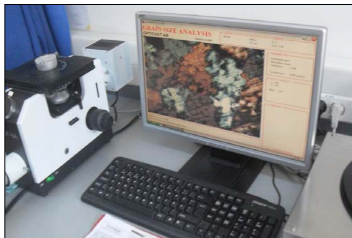
Fig.5.26. Microscop XJP-6A pentru determinare dimensiuni grăunți
