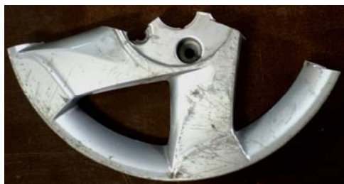
Fig.6.1. Aspectul jantei rupte (partea exterioară)
