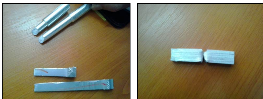
Fig.4.10. Epruvete folosite pentru încercarea la tracțiune și încovoiere prin șoc
