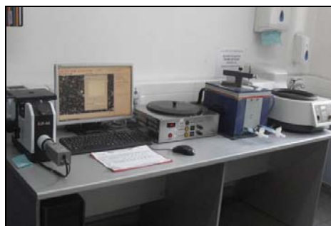
Fig.5.23. Aparatură necesară pentru determinarea dimensiunilor grăunților
