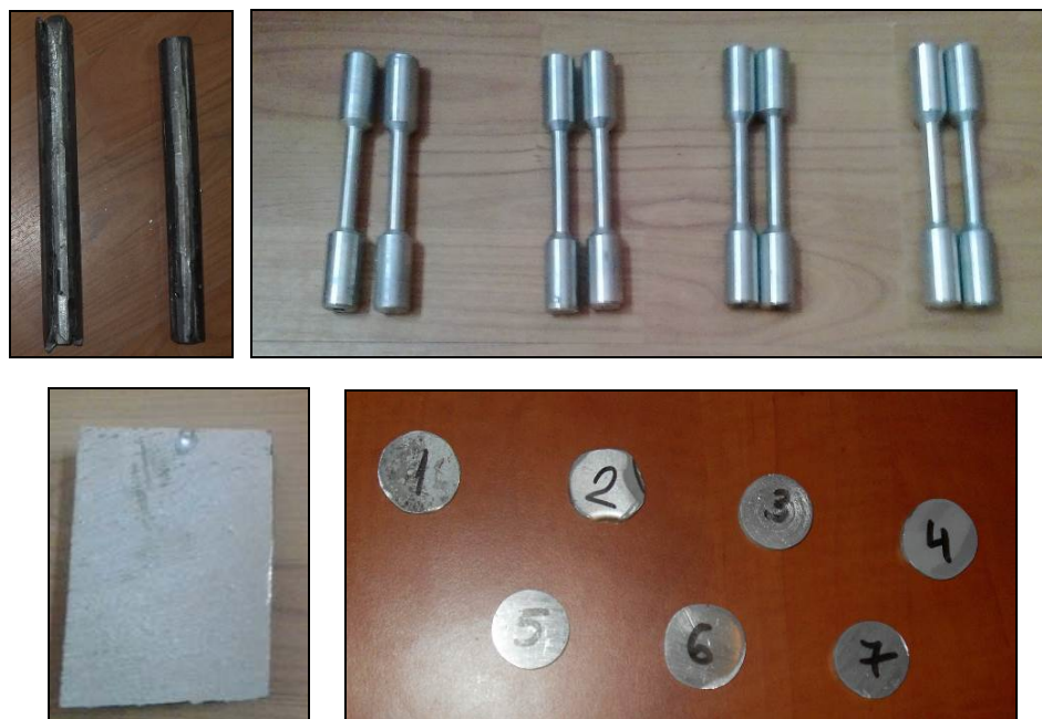
Fig.4.8. Probe forjate și epruvete pentru determinarea caracteristicilor de rezistență
