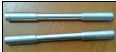
Fig.5.37. Eșantioane din bară pentru epruvete
