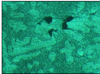
Fig.6.6. Microstructura MB [Atac F1, 100x]
