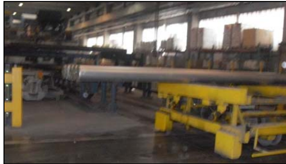
Fig.5.31. Pregătire bare pentru introducere în cuptor
