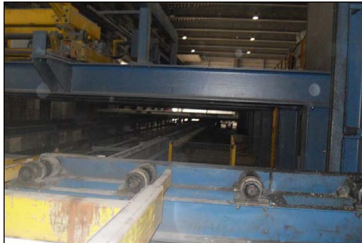
Fig. 5.35. Ieșire bare din cuptor, după tratamentul de recoacere
