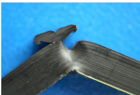
Figura 6.25 Epruvetă fisurată în zona ZIT – încercare la încovoiere la o temperatură de referință de -20^{\circ}\text{C}
