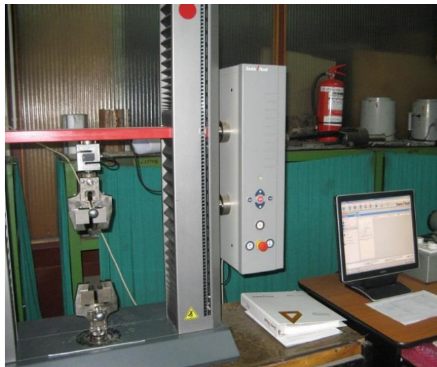
Figura 4.29 Mașină de încercare la tracțiune în regim static Zwich/Roell Z005
