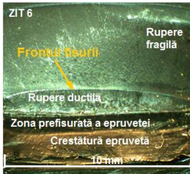
Figura 5.16 Suprafața de rupere a epruvetei S1.6 (ZIT)
