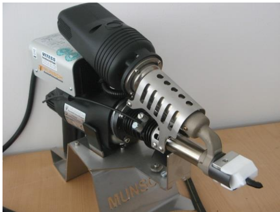
Figura 3.4 Sudare cu material de adaos extrudat - Echipament de tip MUNSCH – MAK 18
