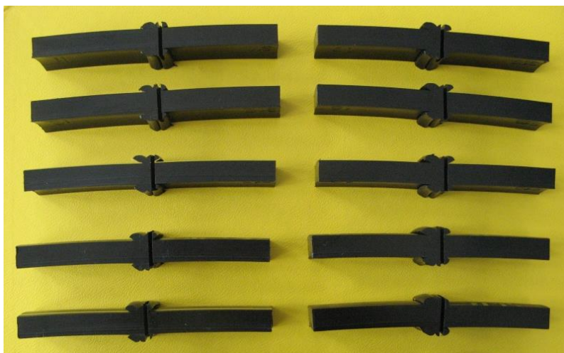
Figura 5.11 Epruvete cu creștătură în ZIT destinate pentru încercarea la încovoiere în trei puncte
