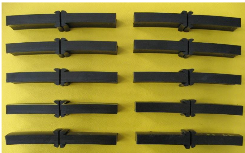
Figura 5.12 Epruvete cu creștătură în sudură (SUD) destinate pentru încercarea la încovoiere în trei puncte
