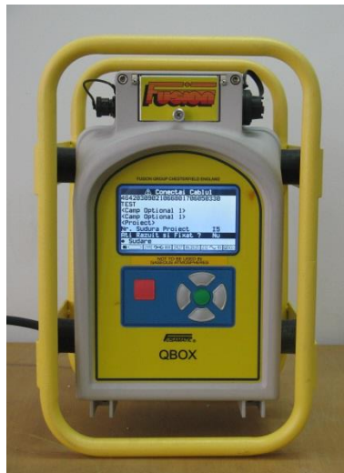
Figura 3.3 Sudare prin electrofuziune - Echipament de tip FUSION - QBOX
