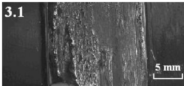
Figura 6.46 Suprafață de rupere epruveta 3.1 - rupere în sudură [149]
