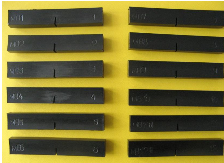
Figura 4.30 Epruvete prelevate din material de bază PE100 (MB), prelucrate cu creștătură pentru încercarea la încovoiere în trei puncte
