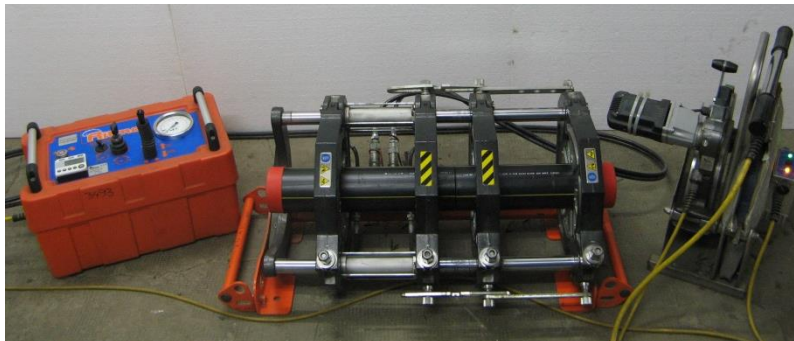
Figura 3.10 Răcirea îmbinării sudate sub presiune
