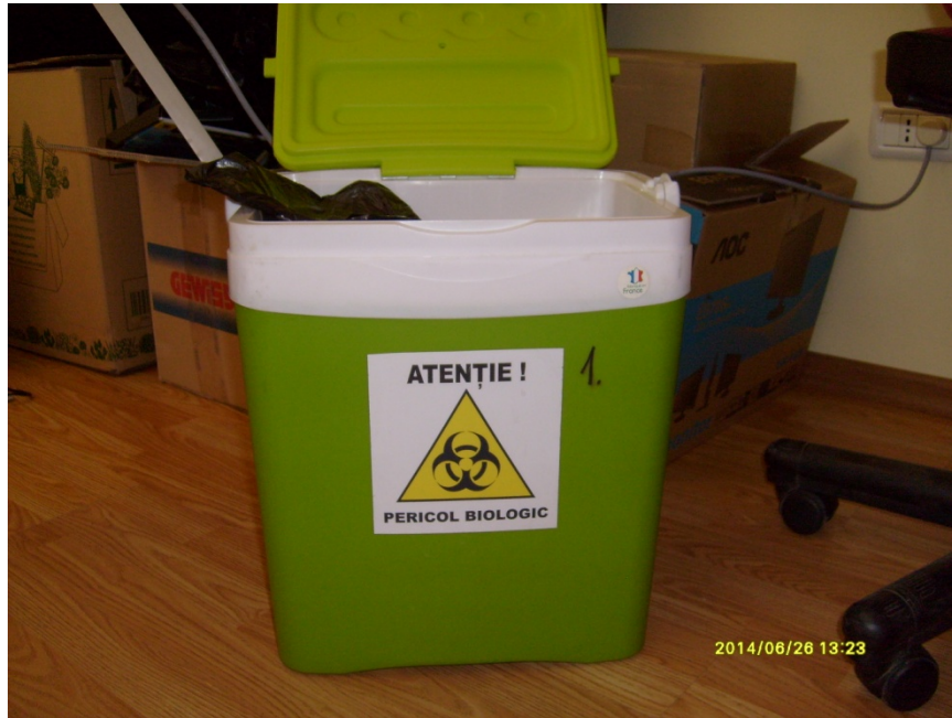
Fig. 7.33. Container termo-etans pentru transportul probelor de aer contaminat.
