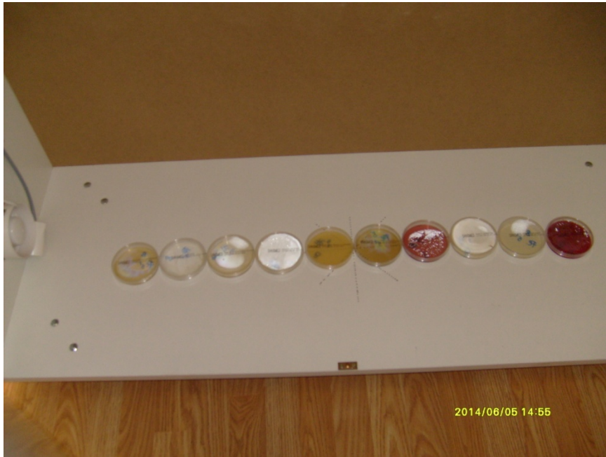
Fig. 7.8. Medii de cultură după prelevarea probei de aer (amprenta în mediul de cultură a fluxului de aer purtător de particule).
