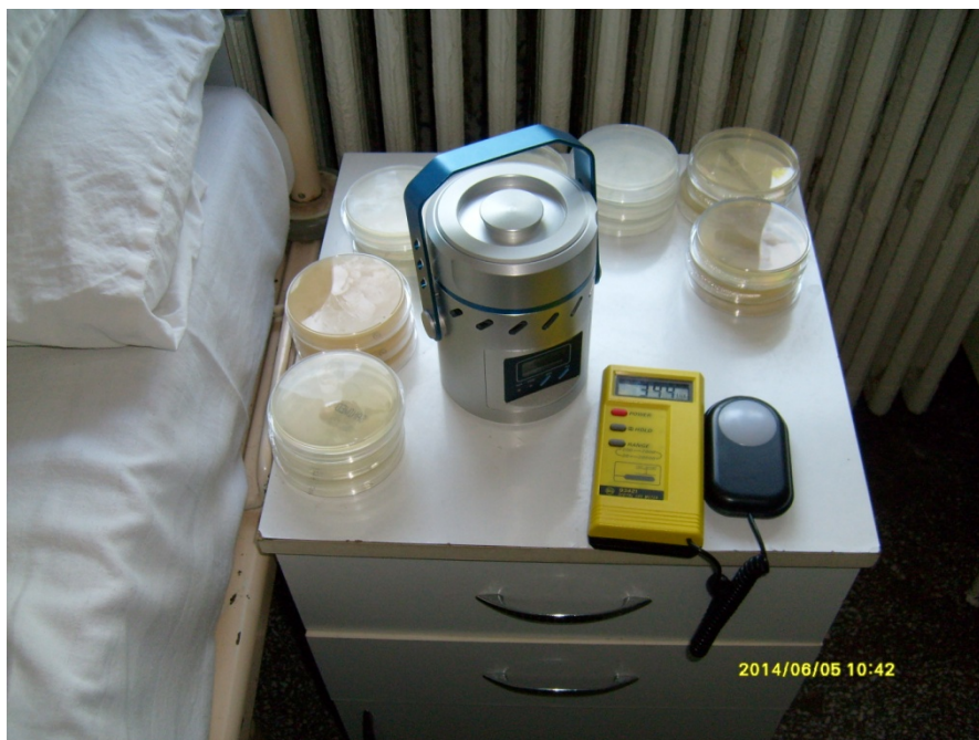
Fig. 7.7. Aparat pentru prelevat probe de microaerofloră model MAS-100 Eco utilizat la excutarea de măsurători.
