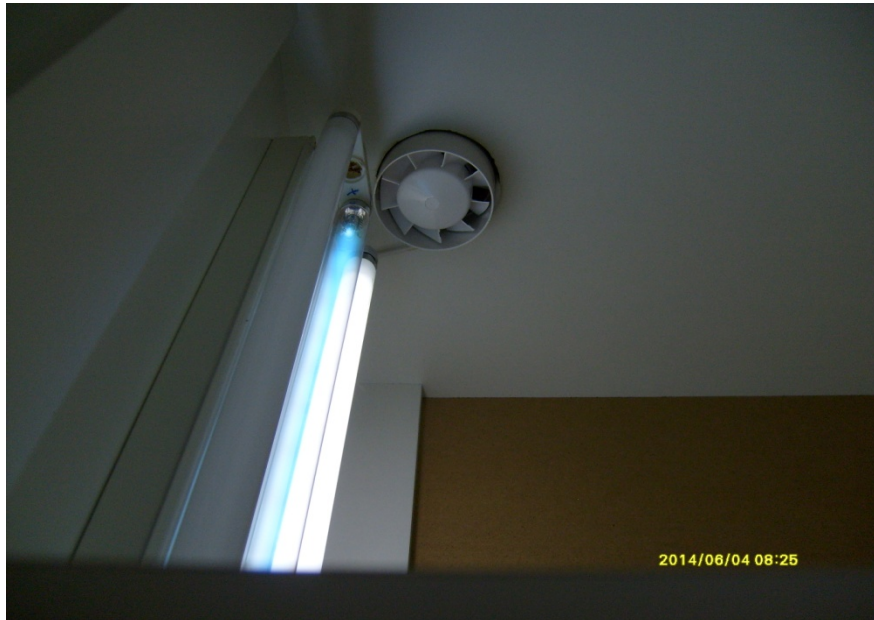
Fig. 7.6. Lampa UV-C și lămpile fluorescente T5 cu Ra=94 și 5200 K în modelul experimental necesar măsurătorilor parametrilor de microaerofloră.
