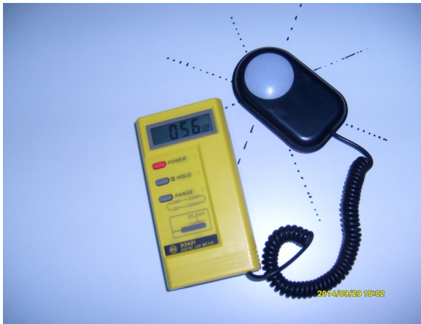
Fig. 7.30. Intensitatea luminoasă a radiației germicide UV-C.
