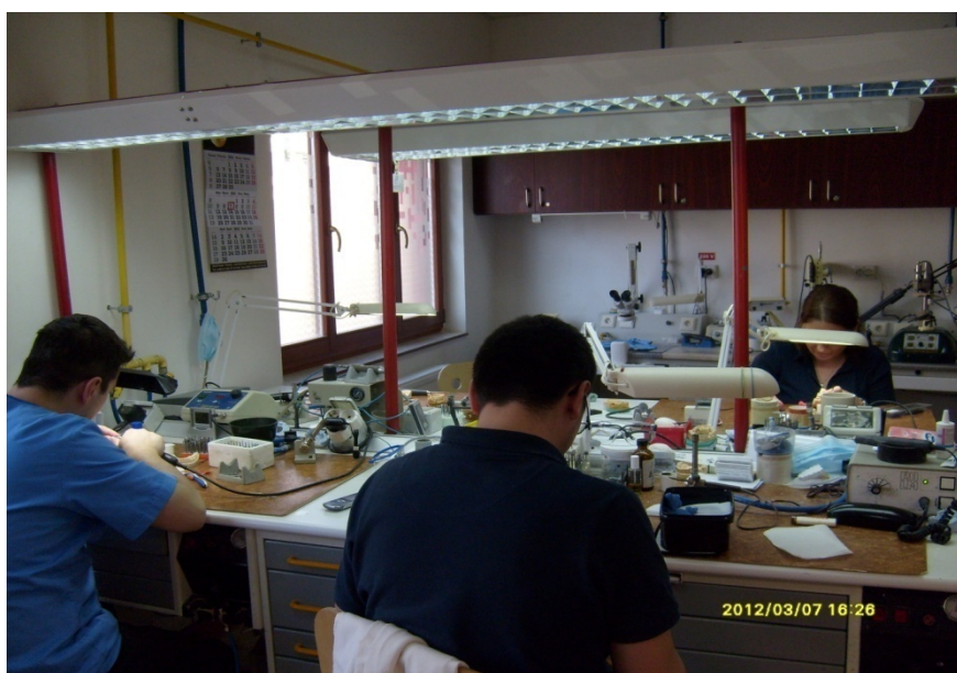
Fig. 5.8. Laborator de tehnică dentară cu iluminat local la masa tehnicianului.
