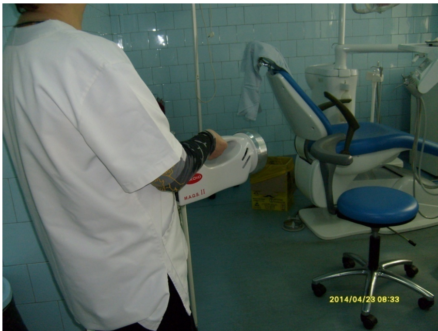
Fig. 7.28. Prelevare de probă de aer într-un cabinet dentar.
