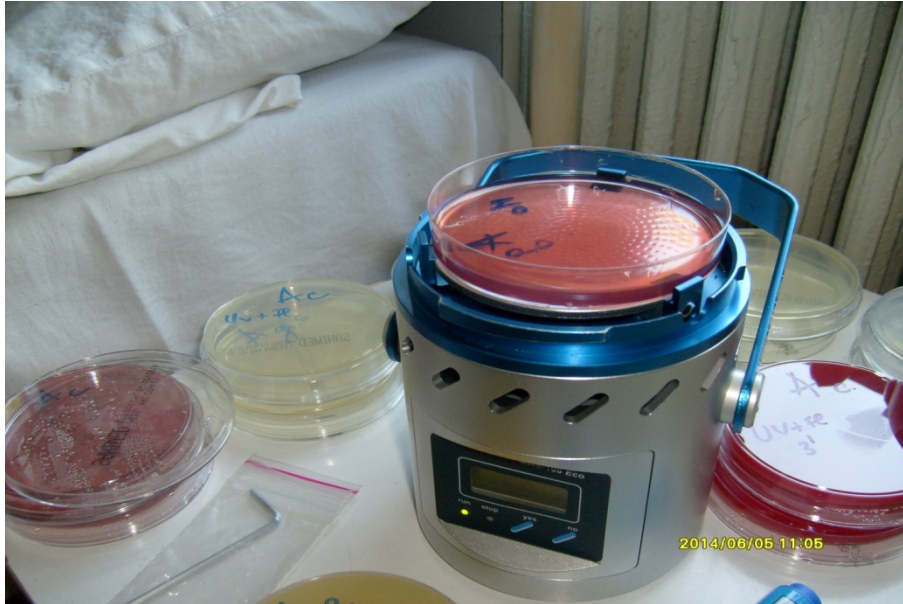
Fig.3.5.1. Aparat pentru analiza parametrilor de microaerofloră din unitățile medical dentare.
