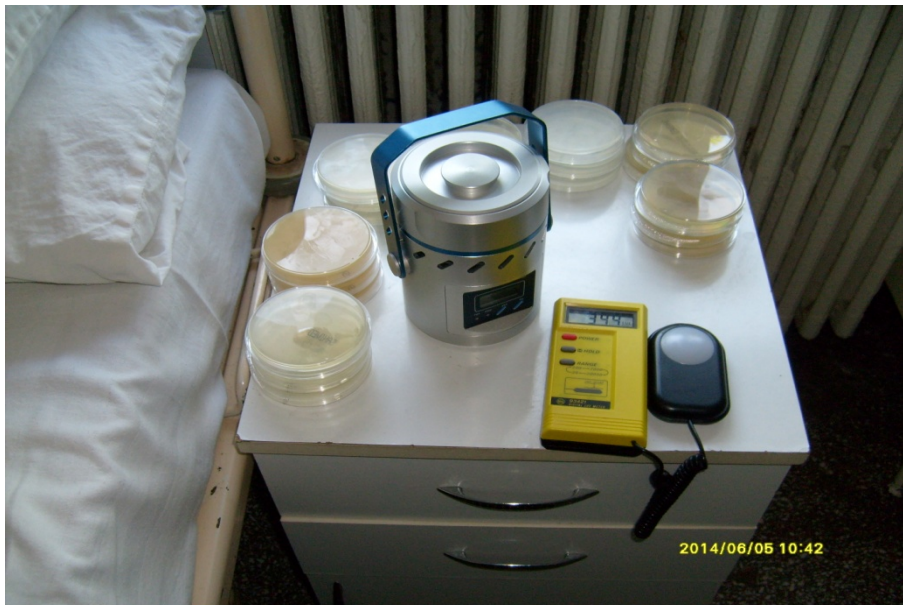
Fig.3.5.2. Aparat pentru analiza parametrilor de microaerofloră din unitățile medical dentare și luxmetru pentru măsurarea nivelului de iluminare.
