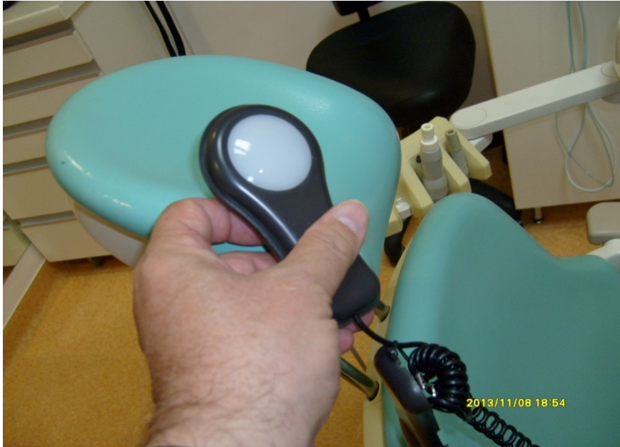
Fig. 5.11. Efectuarea de măsurători ai parametrilor luminotehnici pe unitul dentar.
