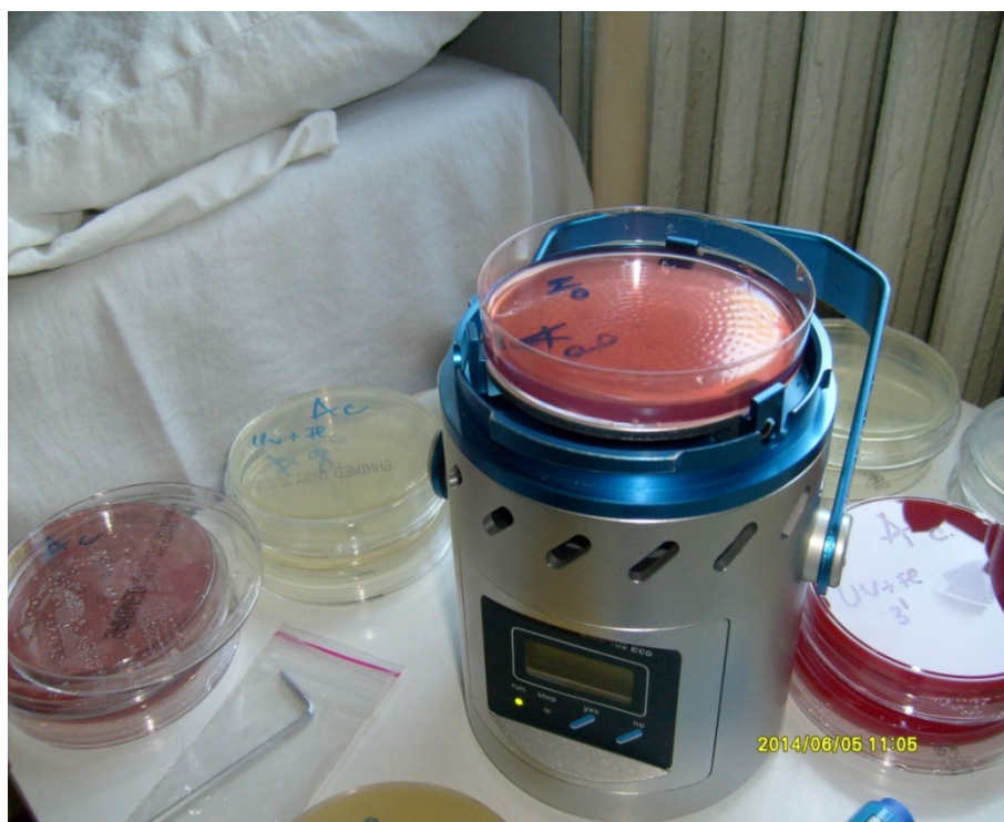
Fig. 7.26. Aparat pentru efectuarea de măsurători a parametrilor de microaerofloră din aer.
