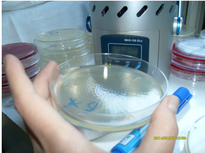
Fig.7.12. - Mediul de cultură după prelevarea probei de aer (amprenta în mediul de cultură a fluxului de aer purtător de particule).
