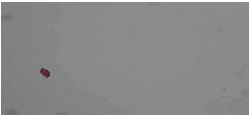
Fig.4.10. Apă din instalația de decontaminare. Frotiu de aspect curat cu rare scuame celulare anucleate.
