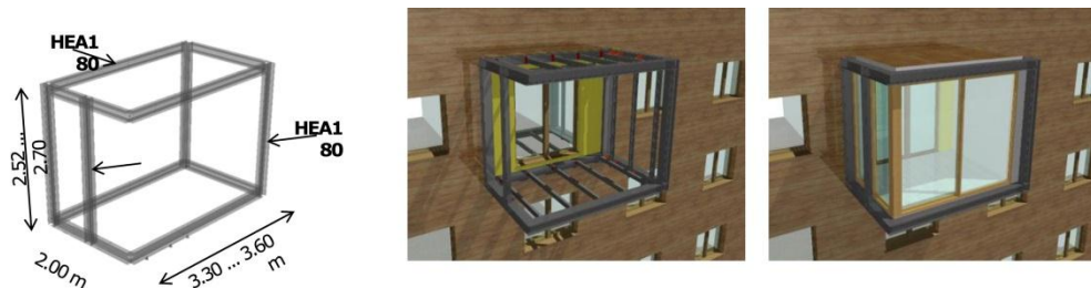
Figura 66. Dimensiunile, structura și închiderile modului prefabricat
