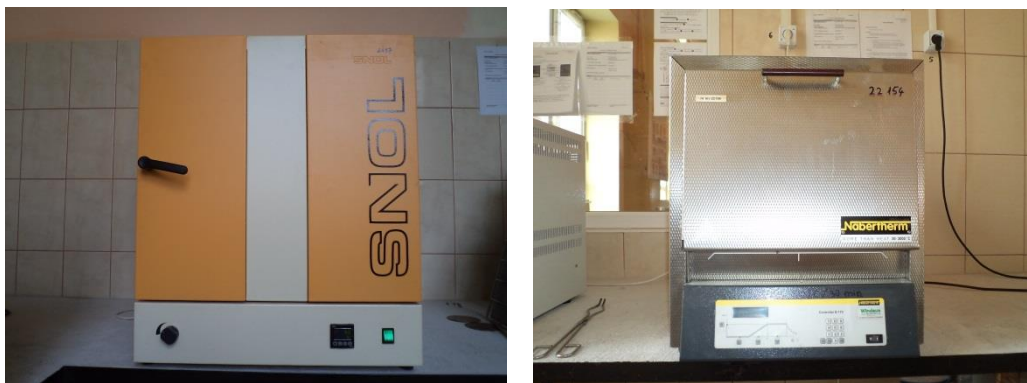
Figura 10.2 a) Etuvă destinată sintezei hidrotermale, b) cuptor destinat tratamentelor termice în aer
