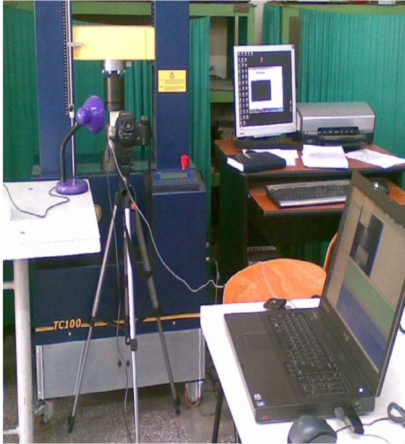
Fig. 3.1. Imaginea de ansamblu a mașinii de încercat și sistemul ARAMIS 2D
