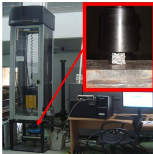
Fig. 4.15. Imaginea de ansamblu a mașinii de încercat Instron-Dynatup
