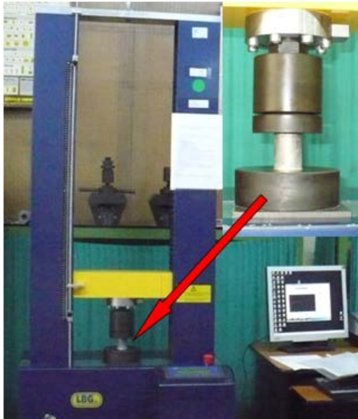
Fig. 4.41. Mașina de încercat LBG A009, 100 kN
