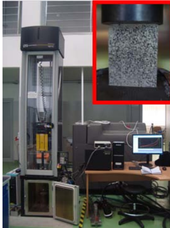
Fig. 2.53. Imaginea de ansamblu a mașinii de încercat Instron-Dynatup. Compresiune dinamică.
