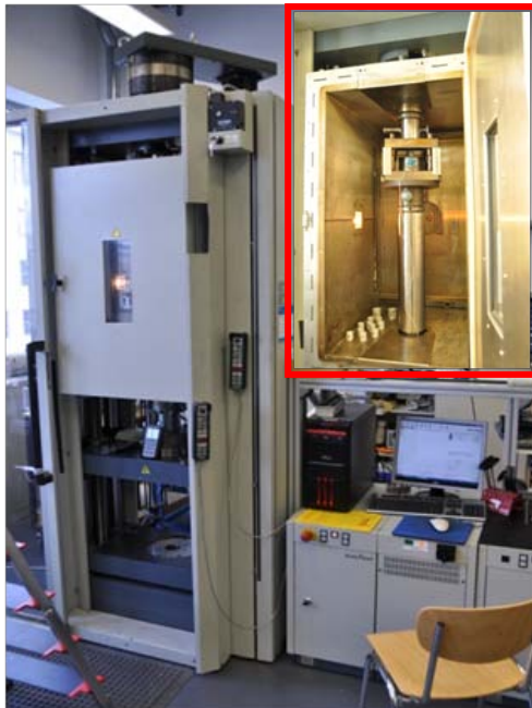
Fig. 2.37. Mașina de încercat Zwick/Roell 10 kN dotată cu incintă termică.
