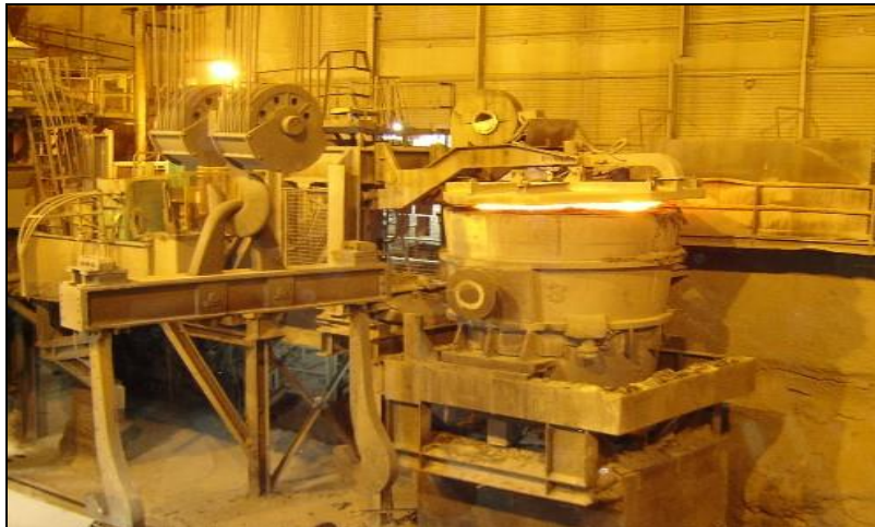
Fig.5.7. Oala de turnare cu oțel lichid, [4]
