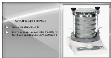
Figura 4.6. Aparat de sitare Fritsch tip Analysette 3 Spartan
