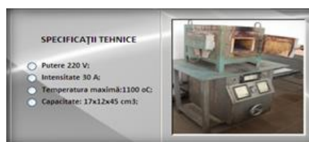
Figura 4.15 . Cuptor cu rezistori
