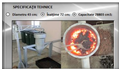
Figura 4.10 . Instalația de aglomerare
