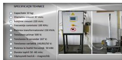
Figura 4.17. Cuptor cu inducție
