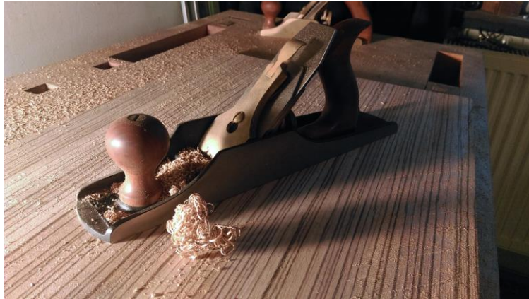
Figură 6.48 Rindea cu lama dințată – detaliu prelucrare suprafață
