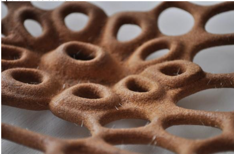
Figură 3.7 Imprimare 3D folosind compozit celulozic
