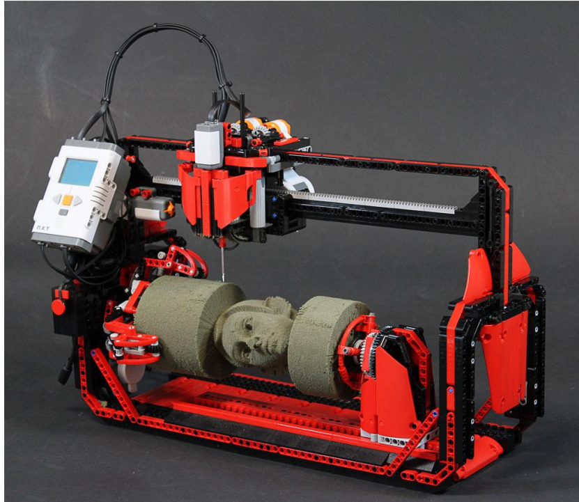
Figură 4.48 Arthur Sacek Sistem CNC realizat din Lego
