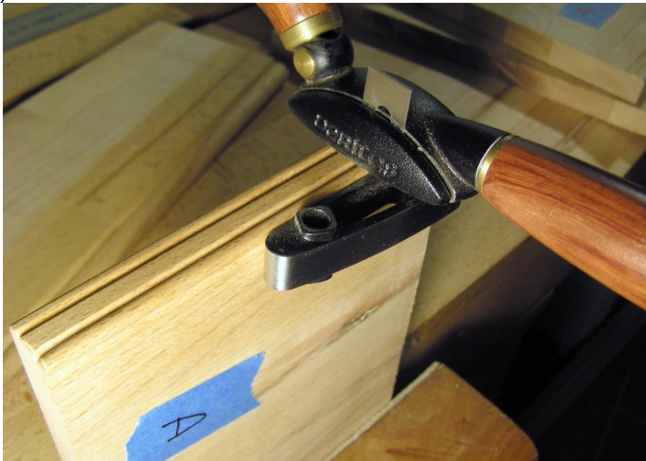
Figură 6.17 Realizarea manuală a profilului inițial D folosind o lamă profilată special pentru aplicație
