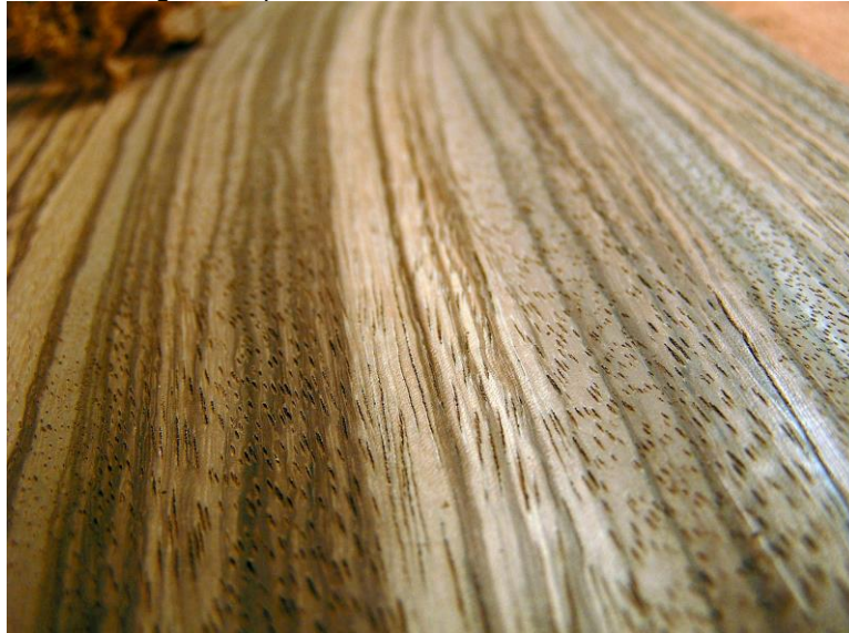
Figură 6.49 Pregătire prin rindeluire manuală. Unghi ridicat al lamei (55°) pentru lucrul în esențe cu fibră reversibilă
