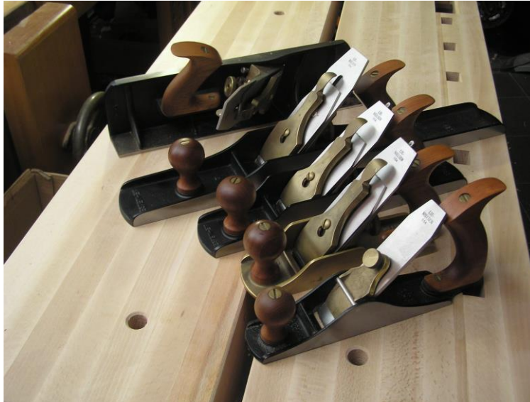
Figură 4.29 Rindele manuale contemporane produse de Lie Nielsen. Replici moderne, superioare, bazate pe rindelele Stanley Bedrock
