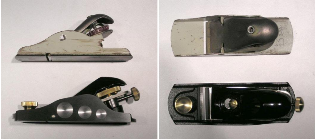
Figură 4.28 Rindele manuale. Sus producție sovietică, anii 1980. Jos rindea produsă de Veritas, Canada, 2010
