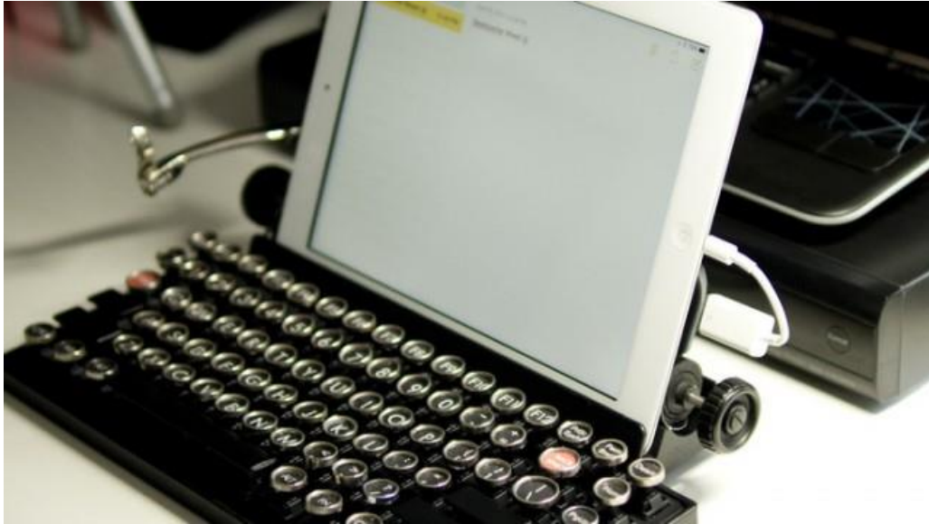
Figură 5.43 Qwerkywriter. Tastatură mecanică atașată unei tablete
