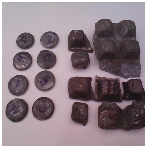
Figura 3.6. Brichete turnate realizate din aliaje activante chimic.
