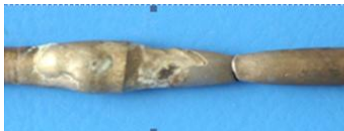
Figura 5.8. Epruvetă solicitată la tracțiune.
