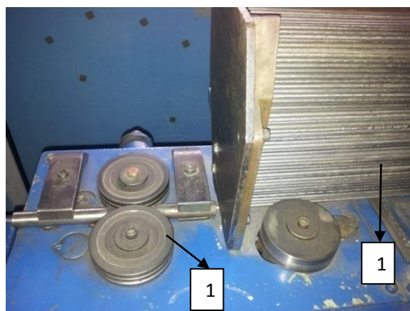
d) 1- role de antrenare din oțel; 2-vergele în mișcare.
