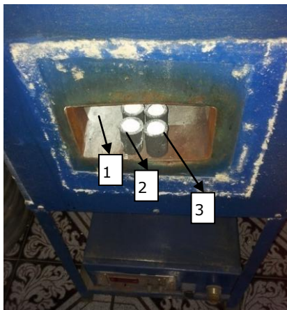
Figura 2. Epruvete de analizat. 1-masă omogenizată; 2-incintă calibrată din grafit; 3-cuptor cu protecție de argon.
