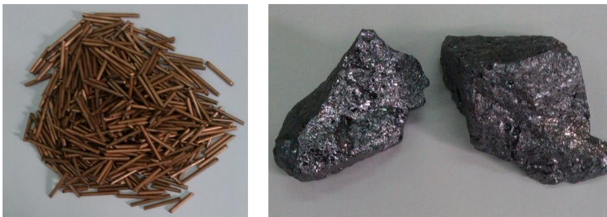
Figura 3.4. Cupru fosforos și siliciu metalic utilizate pentru realizarea șarjelor experimentale.
