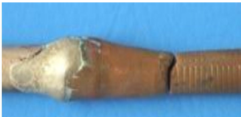
Figura 5.21. Epruvetă solicitată la tracțiune.
