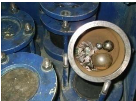
Figura 3.23. Moară planetară cu încărcătură în cuib.
