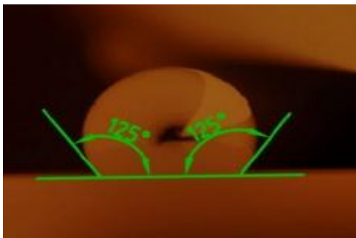
Figura 4.9. Unghiuri de umectare (\alpha_1 + \alpha_2)/2 .
