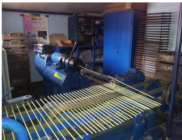
Figura 4.1. Linie de fabricație vergele învelite pentru brazare.
