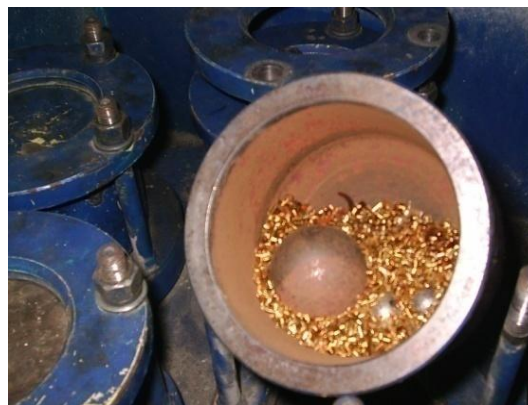
Figura 3.28. Incărcătură de șpan în cuib.
