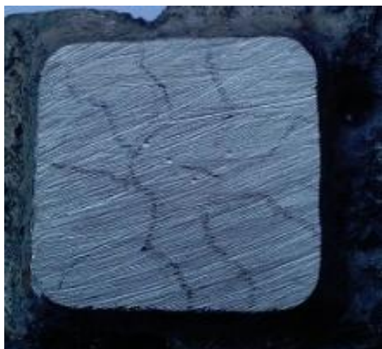
Figura 3.21. Precursor fragilizat, tratat termic la 400°C.
