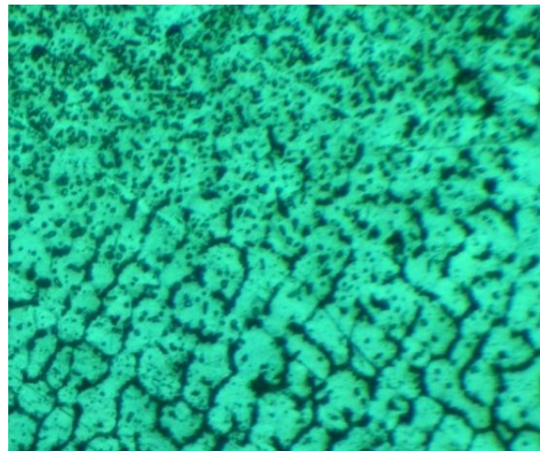
Figura 3.10. Microstructura aliajului bifazic 80%Cu-15%Sn-3%Si-2%P. Mărire 100x.
