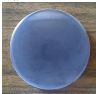
Figura 5.28 Mostră finisată cu hârtie abrazivă P 1200,
