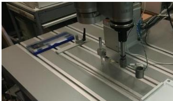
Figura 6.21 Standul experimental utilizat pentru testarea posibilității de utilizare a corecției pe axa z
