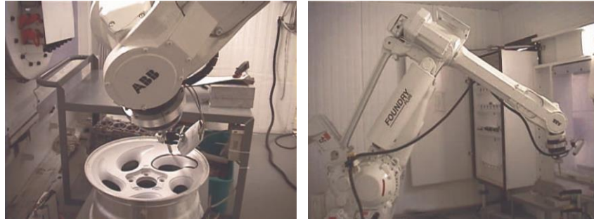
Figura 2.23 Robotul ABB 6400 în aplicații de debavurare a jantelor din aluminiu [Zhang, 2006].
