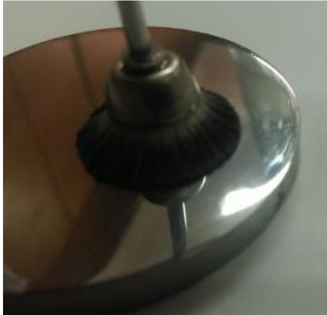
Figura 5.30 Perie de șlefuit în contact cu piesa
