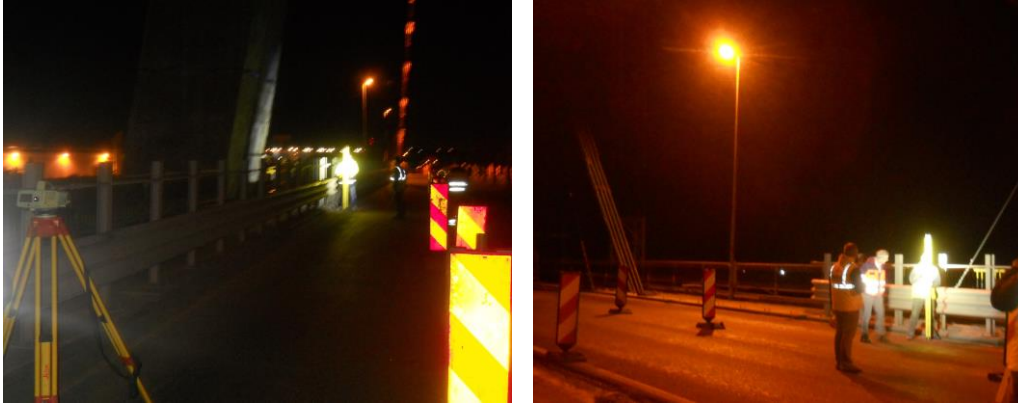
Fig. 4.14. Nivelment geometric pe timp de noapte
