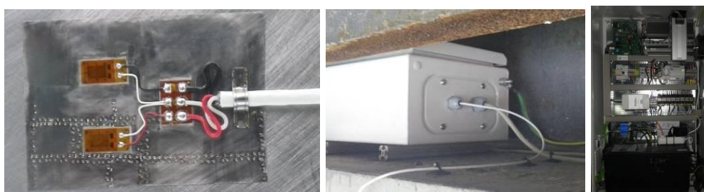
Fig. 4.38. Senzor, cutie de jonctiune și sistem de achiziție de date
