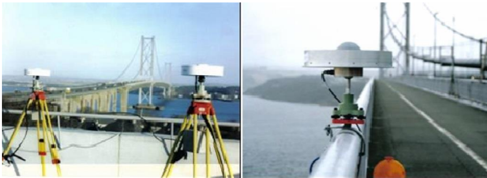
Fig. 3.5. Sistem de monitorizare GNSS pentru Forth Bridge, Edinburgh [74]
