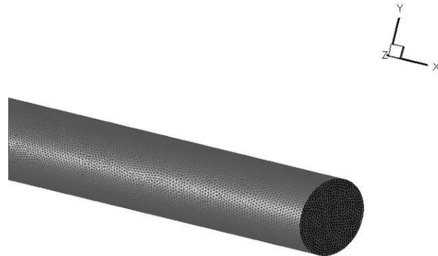
(b) Discretizarea utilizată pentru domeniul investigat; Figura 3.19. Descrierea generală a bypass-ului cu unghi de anastomoză de 45°, poziția suturii grefei L=1D și grad de severitate a stenozei de 90%.
