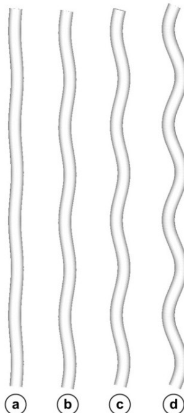
Figura 4.17. Variante geometrice de tuburi elicoidale, cu secțiune circulară constantă, 4 spire și valori diferite ale excentricității: (a) 0,1D ; (b) 0,2D ; (c) 0,3D și (d) 0,5D
