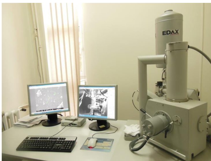
Figura 2.1. Microscopul electronic de baleiaj de tip Inspect S
