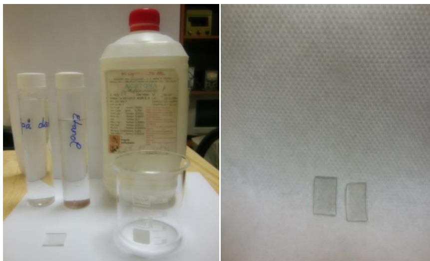
Figura 8.2. Curățarea lamelelor de sticlă FTO
