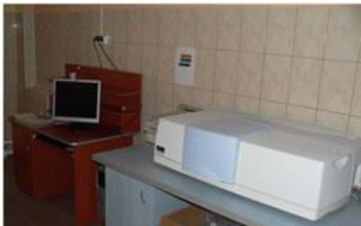
Figura 2.4. Spectrofotometrul UV-Vis- NIR de tip Lambda 950
