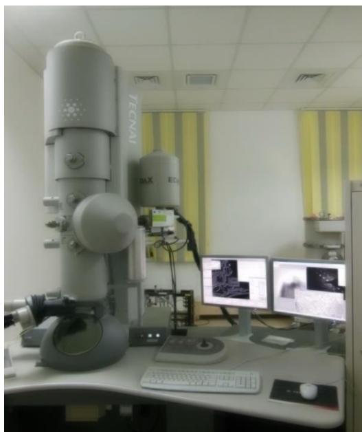
Figura 2.2. Microscopul electronic cu transmisie de tip Tecnai Twin XT G2/200 kV
