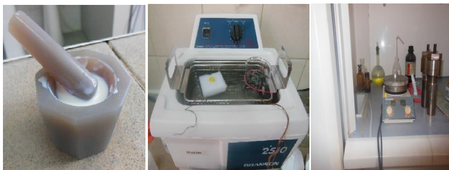
Figura 8.3. Prepararea pastei de ZnO, proba Z5-H-220, pentru realizarea celulelor solare cu semiconductor ZnO sensibilizate cu colorant
