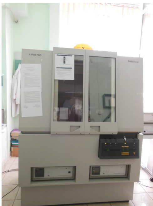
Figura 2.3. Difractometru de raze X de tipu X'Pert Pro MPD
