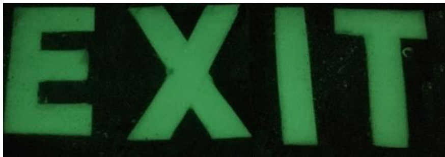
Figura 3.15. Imagine fotografică a marcajului de siguranță obținut supus excitării cu lumină UV cu \lambda=254 \text{ nm} .
