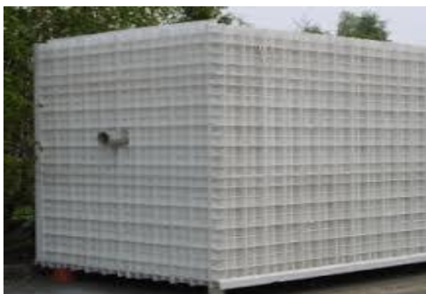
Fig.2.30. Recipient dreptunghiular din poliester armat cu fibră de sticlă.
