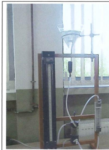
Fig. 4.25 - Aparat pentru determinarea indexului de filtrabilitate
