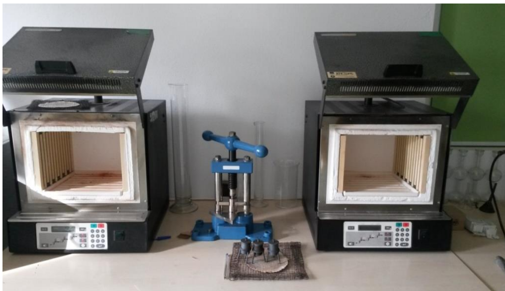
Fig. 4.8 Cuptoare Jencon-Ney pentru pentru determinarea conținutului de volatile, cenușă și carbon fix
