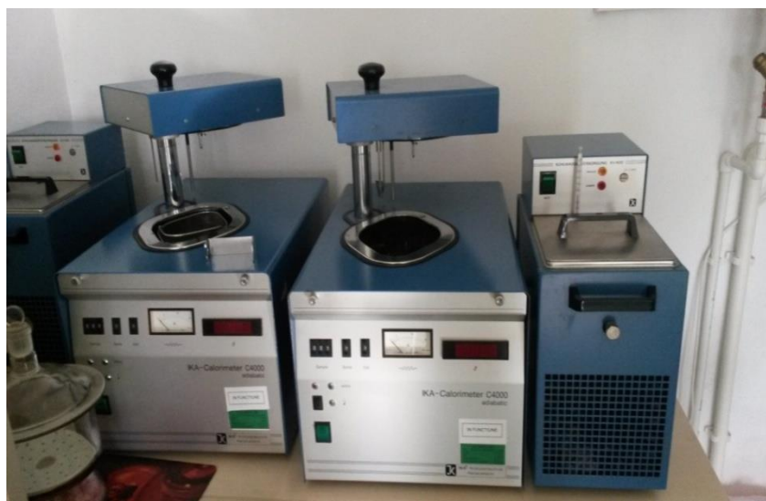
Fig.4.10 Calorimetre IKA C4000 adiabatice, pentru determinarea puterii calorifice a cărbunelui de piroliză
