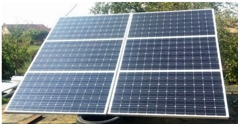
Fig. 5.3 - Ansamblu de panouri folosit în cadrul standului experimental
