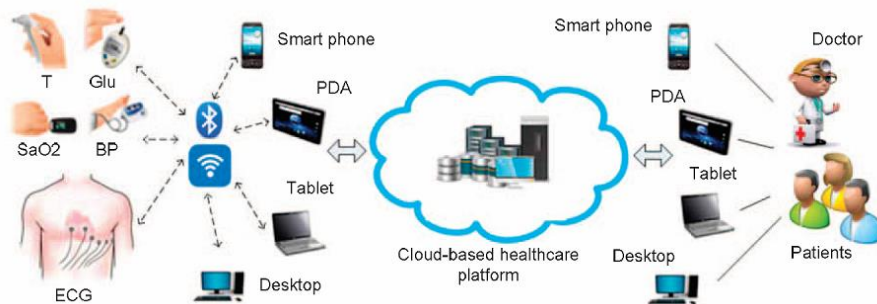
Figura 4.13 Arhitectura sistemului mobil bazat pe cloud computing [ZHI15]
