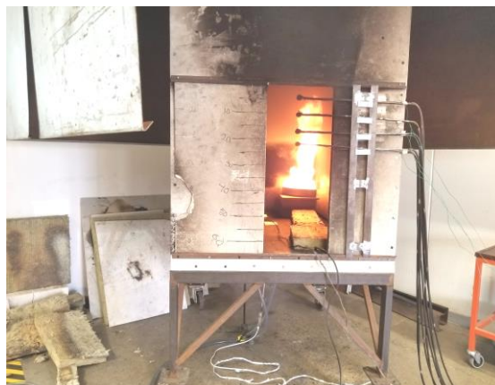
Figura 33. Fotografie ce indică modul de amplasare al balanței electronice
