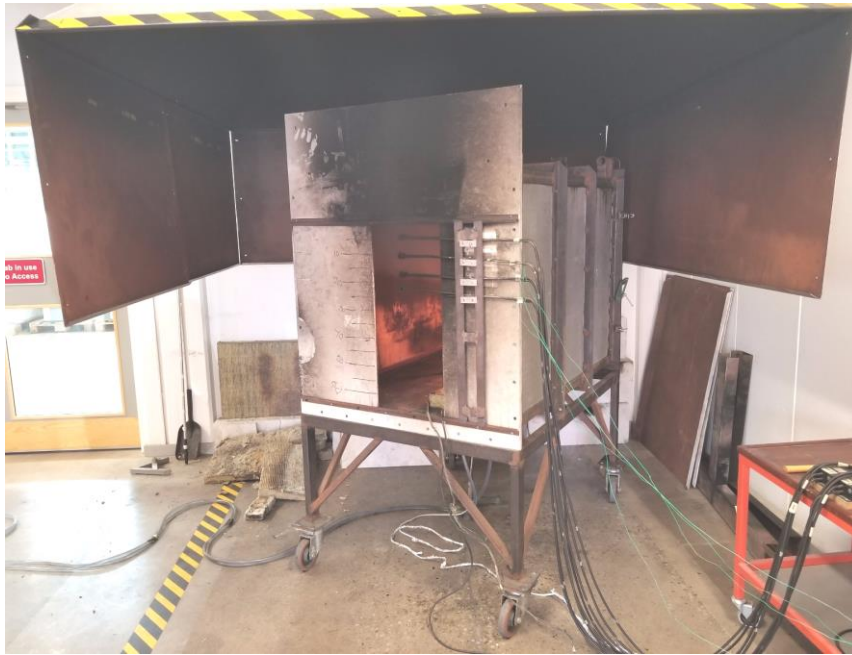
Figura 28. Colectarea gazelor fierbinți pentru determinarea ratei de căldură degajate
