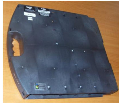
a) b) Fig. 7.20. a) Pila de combustie ReliOn I-1000; b) cartuș ReliOn J48C
