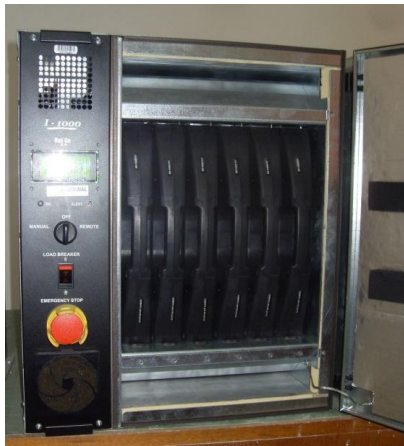
a) b) Fig. 7.20. a) Pila de combustie ReliOn I-1000; b) cartuș ReliOn J48C
