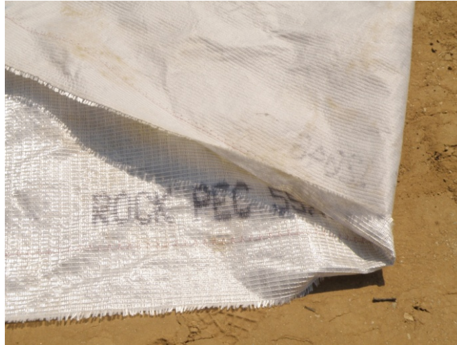
Fig. 5.12. Geocompozit de armare utilizat la terasamentele aferente podului de la Cutina
