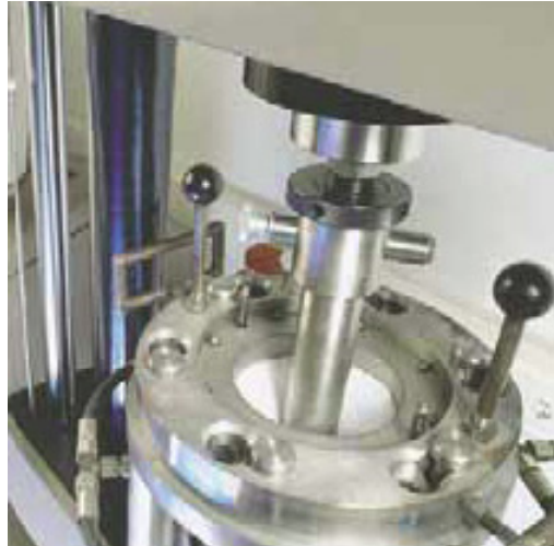
Fig. 3.4. Încercarea de poansonare la geotextile
