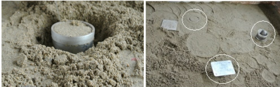
Fig. 3.22. Prelevarea probelor netulburate cu ștanțe de laborator
