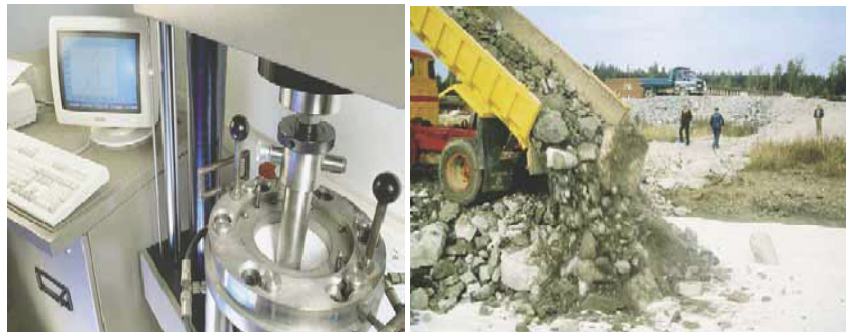
Fig. 2.37. Încercarea de poansonare - simularea efectului împingerii unei pietre prin geotextil, pentru stabilirea clasei de robustețe
