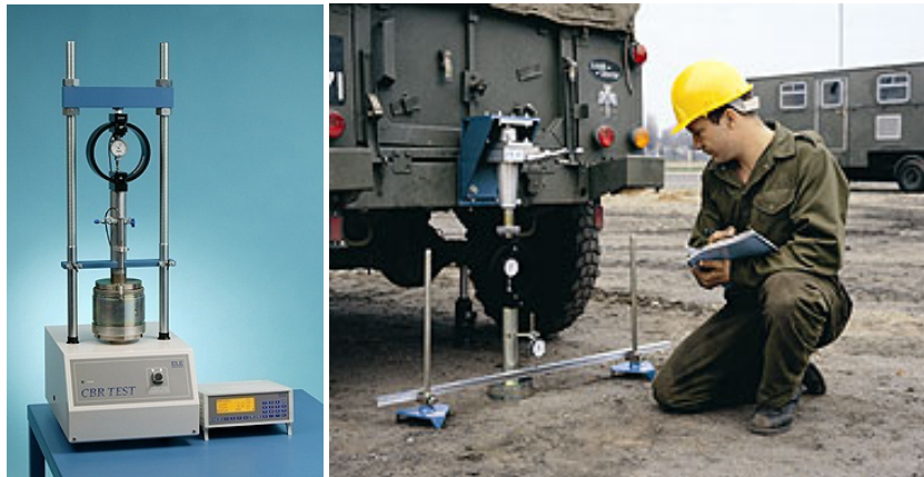
Fig. 2.36. Determinarea rezistenței la poansonare
