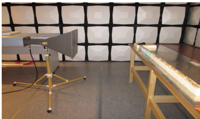
Fig. 3-2 Setup practic pentru DUT utilizând o antenă Horn
