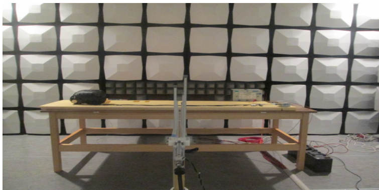
Fig. 2-13 Configurația de test cu antena log-periodică (ALSE1)
