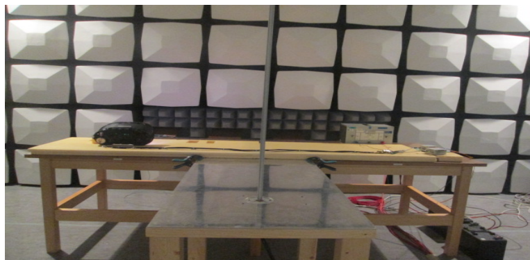
Fig. 2-12 Configurația de test cu antena monopole (ALSE1)
