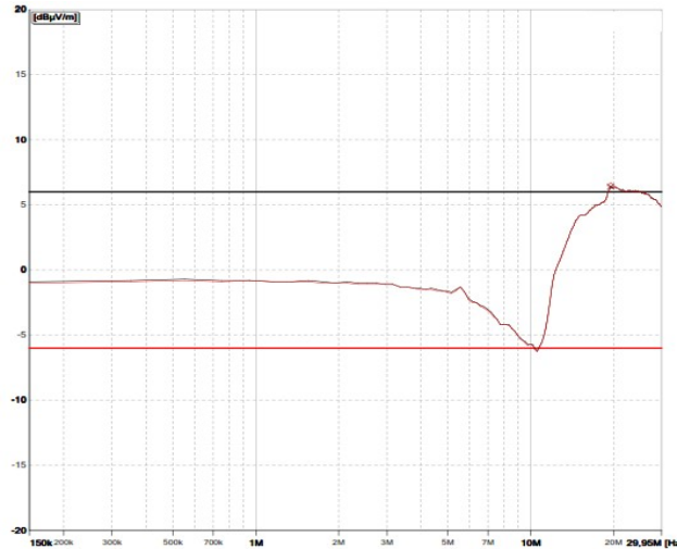
Fig. 2-48 Rularea cu monopol. Pe abscisă: frecvența (Hz), pe ordonată: intensitatea câmpului electric (dB \mu V/m)
