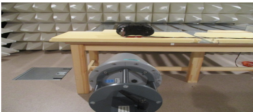
Fig. 2-14 Configurația de test cu antena log-periodică (ALSE2)
