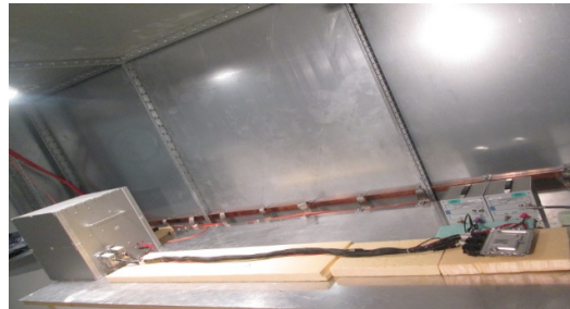
Fig. 2-22 Setup-ul de test pentru emisii conduse
