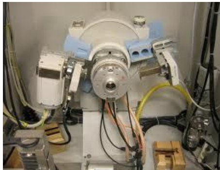
Figura 3.19. Modulul camerei de temperatură Anton Paar HTK 2000 utilizat pentru stabilitatea termică
