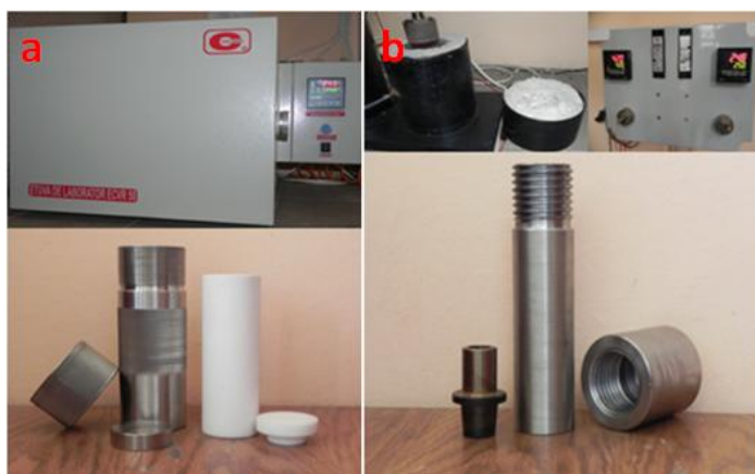
Figura 2.2. Autoclave de laborator și sisteme de încălzire a) temperaturi joase ( < 250\text{ }^\circ\text{C} ), b) temperaturi înalte ( > 300\text{ }^\circ\text{C} )
