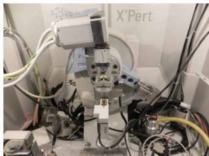
Figura 3.7. Modulul SAXS pentru determinarea dimensiunii particulelor
