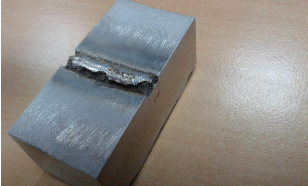
Fig. 5.1 Exemplu de coroziune într-o îmbinare sudată din oțel inoxidabil Duplex
