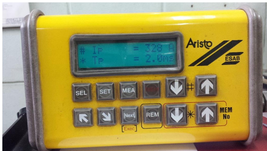
Fig. 2.18 Parametrii I_p , T_p ai curentului pulsant
