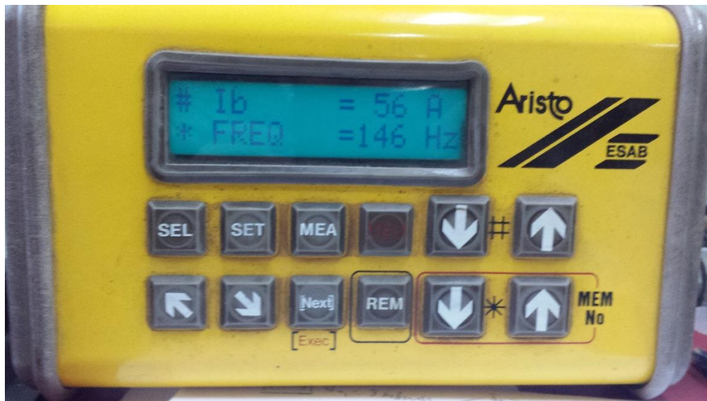
Fig. 2.19 Parametrii Ib, f ai curentului pulsat
