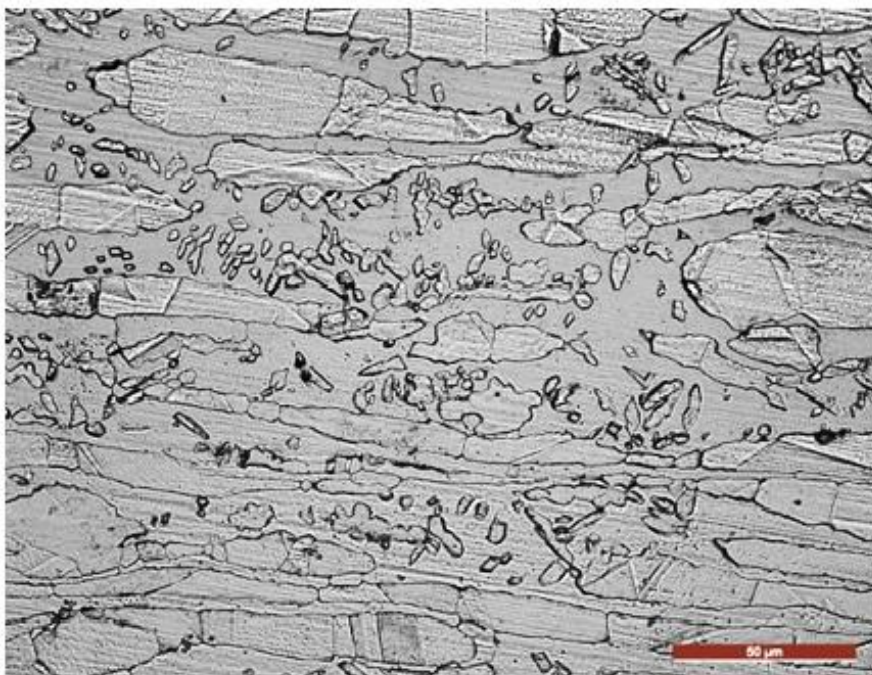
Fig. 4.8 Metale de bază : a – oțel slab aliat ; b- oțel inoxidabil Duplex
