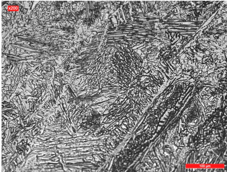
Fig. 5.5 Microstructura cusaturii sudate după tratament termic ulterior sudării
