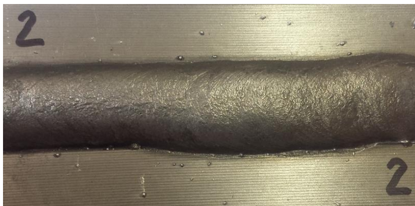
Fig. 2.31 Aspectul suprafeței exterioare a sudurii (foto original)
