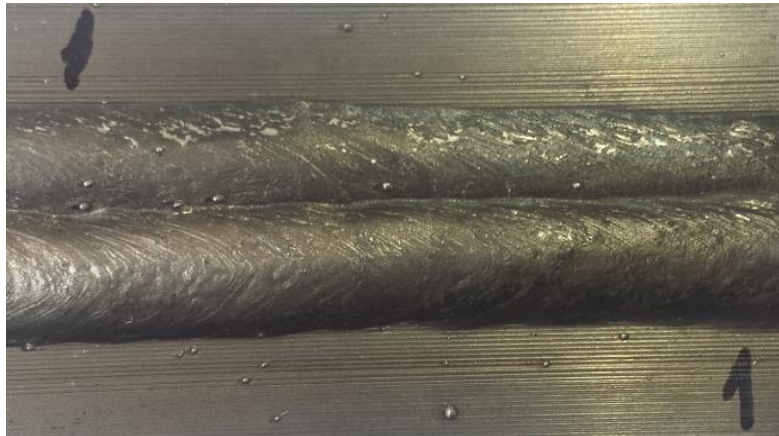
Fig. 2.27 Aspectul suprafeței exterioare a sudurii (foto original)
