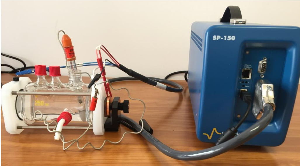
Fig. 5.8 Instalația de voltametrică ciclică SP150
