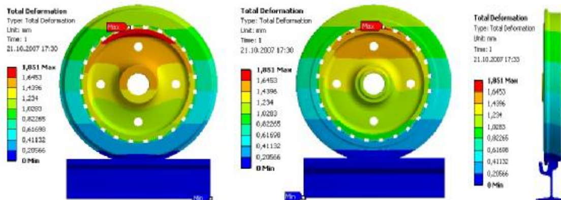
Fig. 2.18. Deformația totală – cazul I de încărcare.
