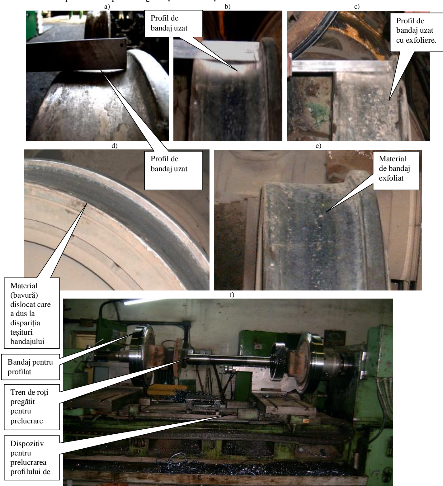
Fig. 2.29. Profil de uzură – a) bandaj conic uzat la 20.000km; b) bandaj conic uzat la 40.000 km, c), d), e) teșitură bandaj distrusă, f) dispozitiv de profilat geometrie bandaj roată elastică.
